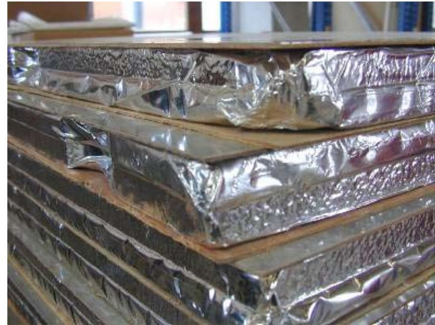
Abb. 79: Vakuum-Isolations-Paneeelen mit Deckschicht (Variotec)
