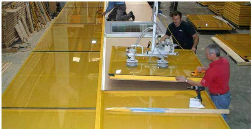
Abb. 85: Montage der raumhohen Fassadenelemente im Werk
