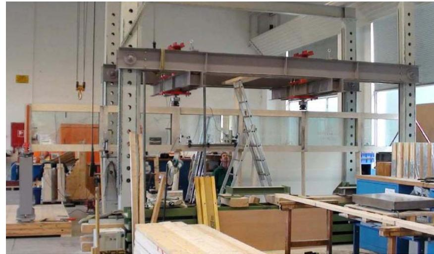
Abb. 71: HGV-Träger auf dem Prüfstand
