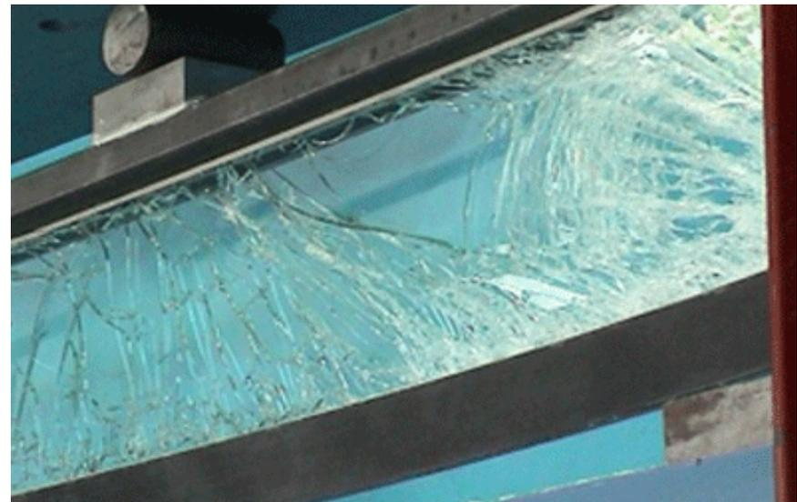
Abb. 73 (oben), 74 (unten): Rissbild der HGV-TRäger im Druckversuch
