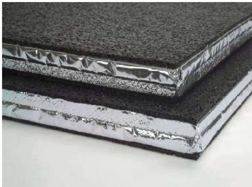
Abb. 77: Vakuu-Isolations-Paneelen mit Gummigranulat-Matten
