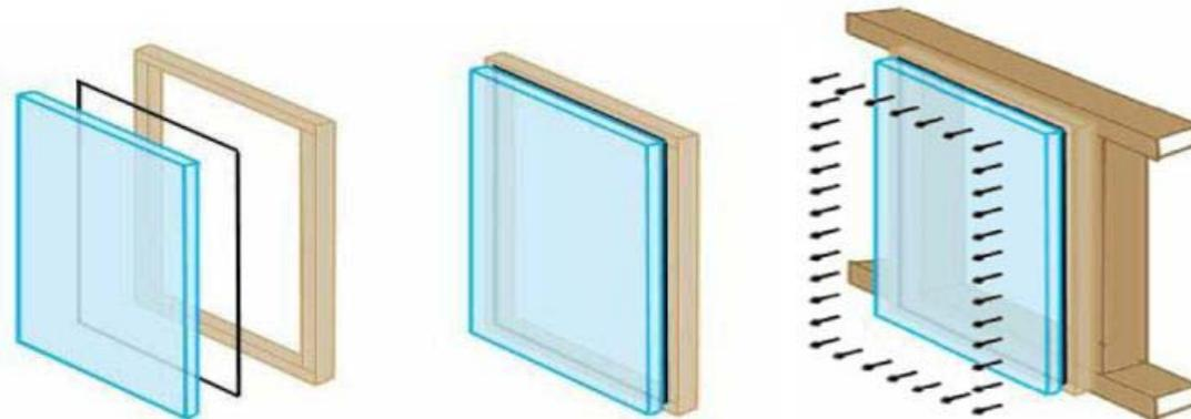
Abb. 59: Montage der Holz-Glas-Verbundfassade
