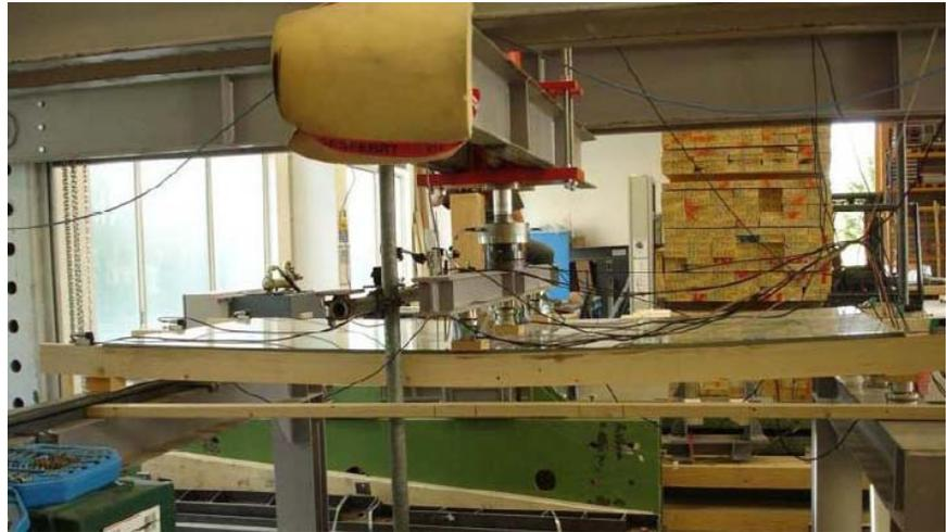
Abb. 68: Holz-Glas-Verbundplatte im Biegeversuch
