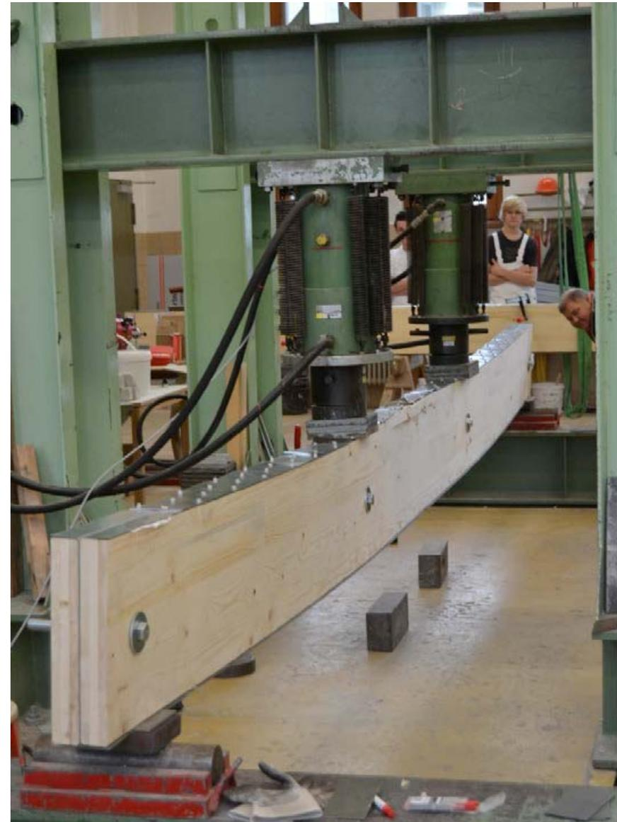
Abb. 50: Holz-Stahl-Verbundträger im Druckversuch
