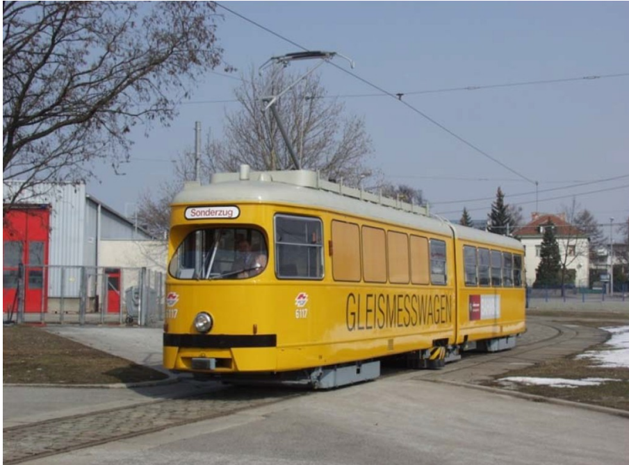
Abb. 1.33: Gleismesswagen E6117 für den Straßenbahnbereich (Bild. H.H. Heider)
