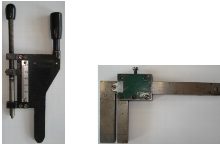
Abb. 1.40: Schiebelehre für die Rillentiefe (links) und für die Rillenweite (rechts)
