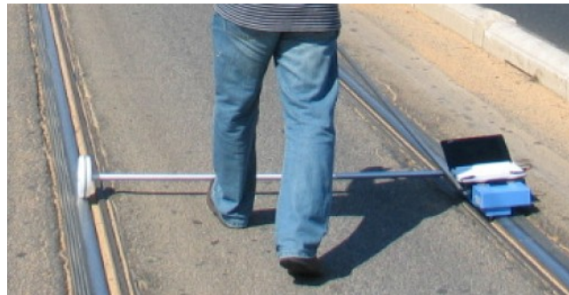
Abb. 1.41: Riffelmessung mit Messsystem CAT (39)
