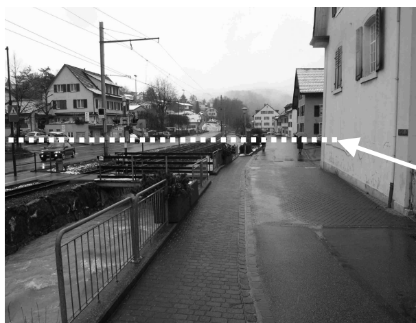
Abb. 3: Die Markierung des Hochwassers vom 16. Juli 1830 (Mittellauf) an einem alten, an der Frenke gelegenen Haus in Niederdorf. Die hydraulische Abschätzung ergab eine Abflussspitze im Bereich von ca. 60 bis 110 m 3 /s.
