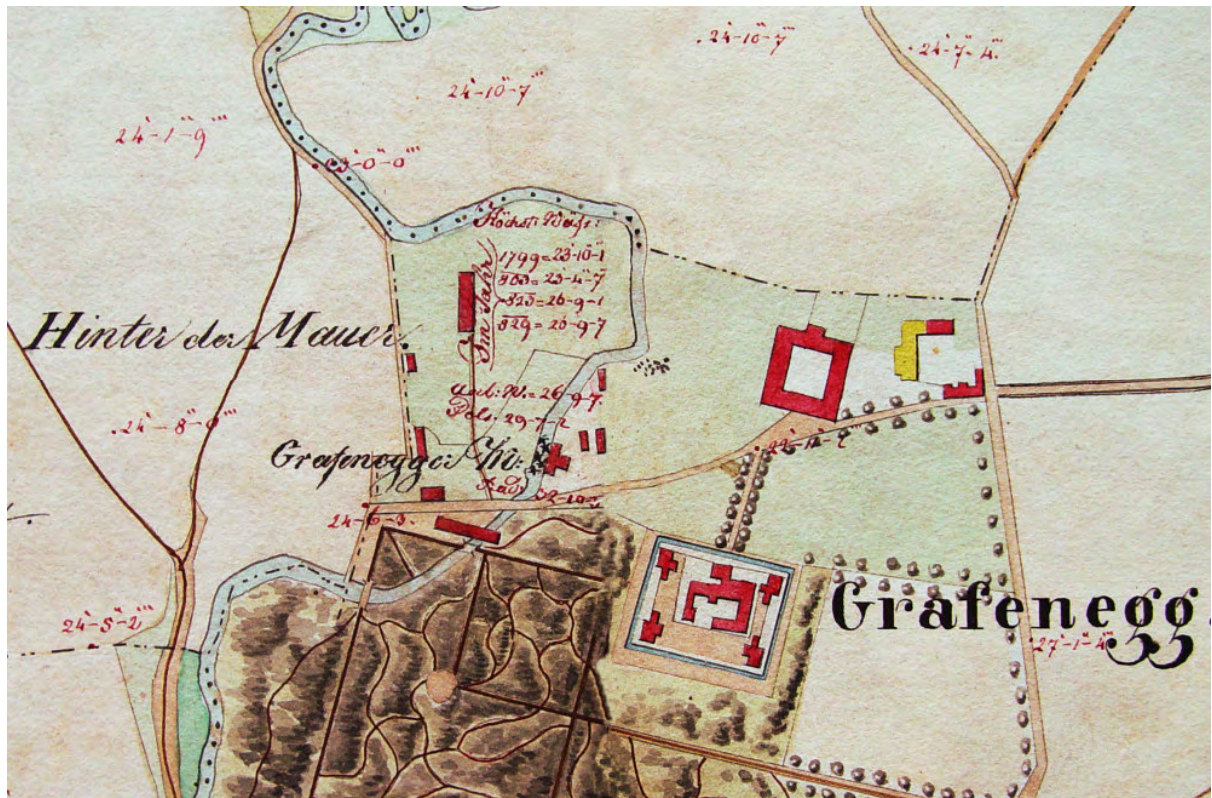
Abb. 4: Planlich dokumentierte Hochwasserstände bei Schlossmühle Grafenegg (1803 = Höchststand, 1799 = H_{1803} - 0,14 cm, 2002 = H_{1803} - 0,48 cm, 1823 = H_{1803} - 1,07 cm, 1829 = H_{1803} - 1,08 cm).
