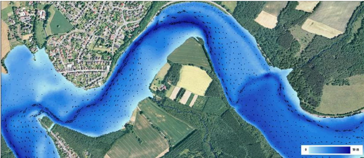
Abb. 8: Überflutungshöhen und Strömungsvektoren, Bereich Niederense für Szenario Q = 2000 \text{ m}^3/\text{s} (Möhnetalsperre) aus 2D Modell MeadFlow
