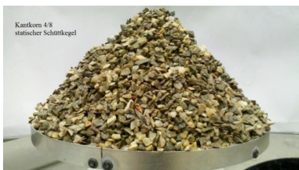
Abbildung 114: Statischer Schüttkegel (Kantkorn)
