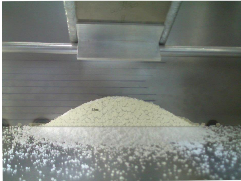
Abbildung 102: y-z Ansicht des Böschungswinkels im Auffangbehälter (Urea)
