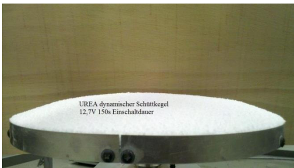
Abbildung 112: Dynamischer Schüttkegel (Urea); li. 150 s Rüttelzeit; re. 16 s Rüttelzeit
