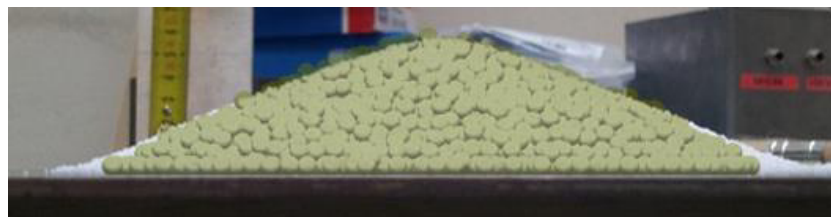
Abbildung 118: Vergleich Simulation mit realem Experiment (statischer Böschungswinkelversuch 2) – Seitenansicht
