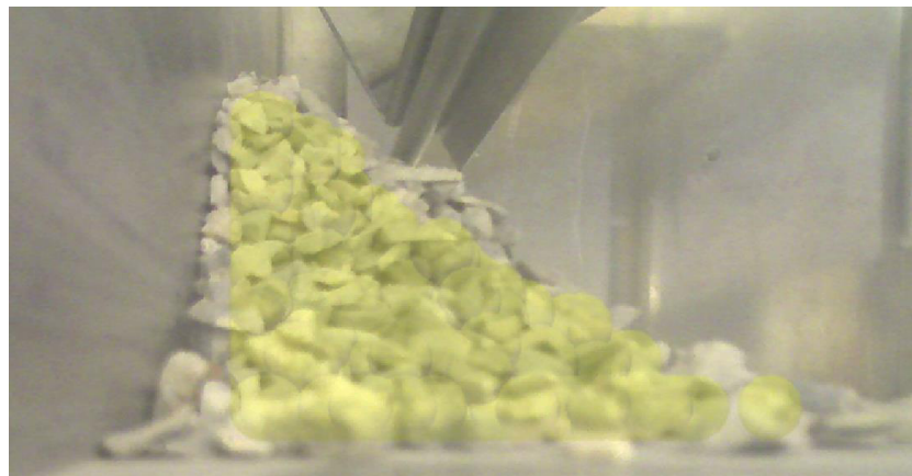
Abbildung 105: x-z Ansicht des Böschungswinkels im Auffangbehälter (Kantkorn)
