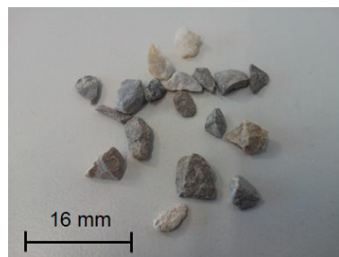
Abbildung 67: Partikelmodelle für das Kantkorn
