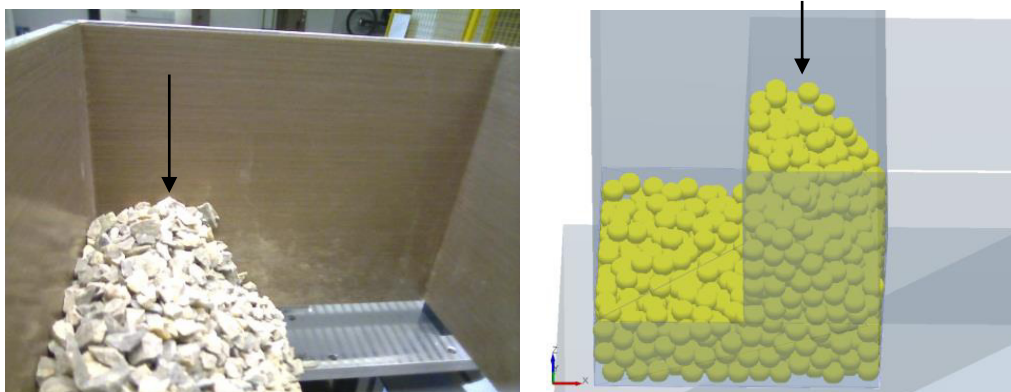
Abbildung 106: Schütthaufen in der oberen Box (Kantkorn)
