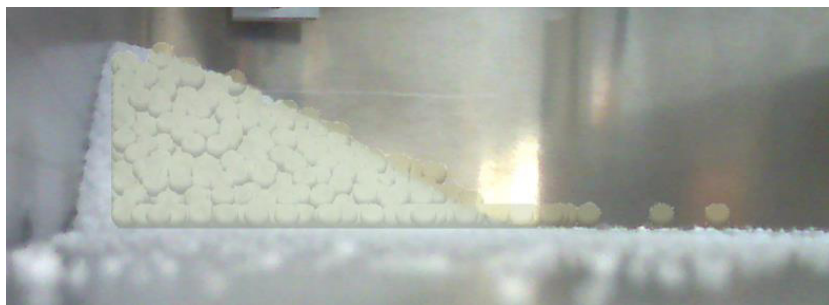
Abbildung 103: x-z Ansicht des Böschungswinkels im Auffangbehälter (Urea)
