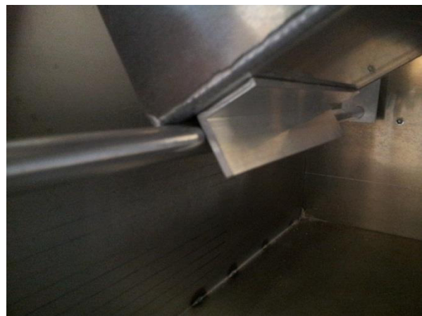
Abbildung 24: Versuchsanlage; li. Niederhalter und Anschläge; re. Anschlag für Rutsche
