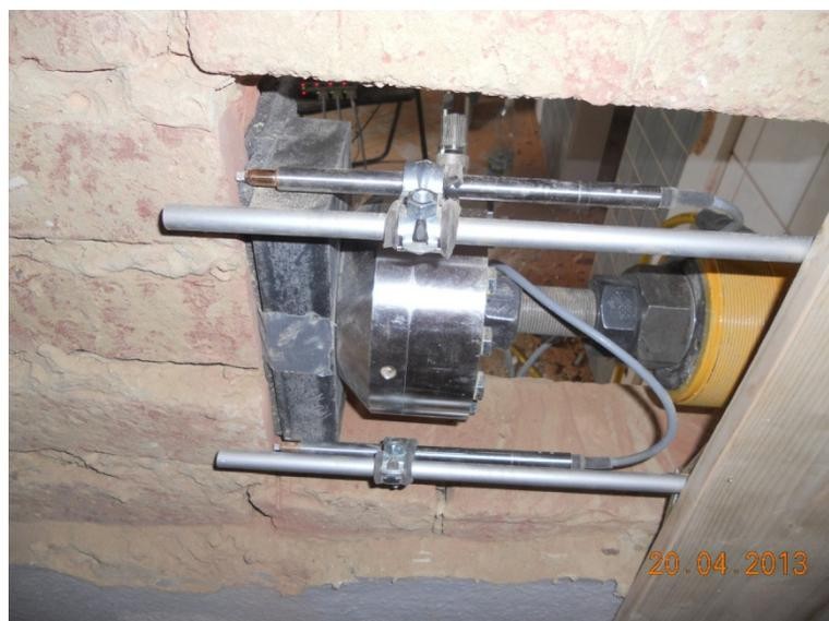
Abb. 17: Wegaufnehmer positionieren
