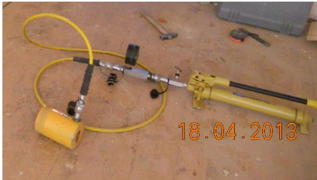
Abb. 10: Presse mit händischer Pumpe
