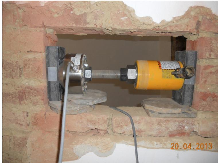
Abb. 16: Einbau der Presse und der Kraftmessdose
