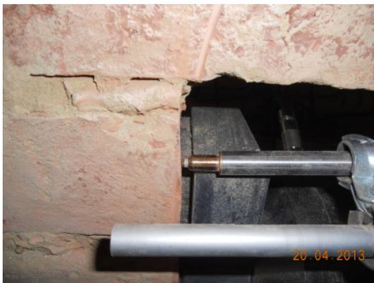
Abb. 84: Wegaufnehmer - Einbauzustand
