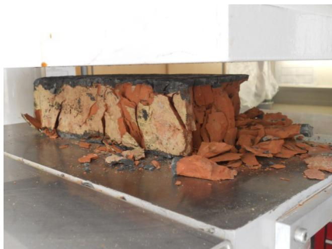
Abb. 4.18: Bruchform des Prüfkörpers
