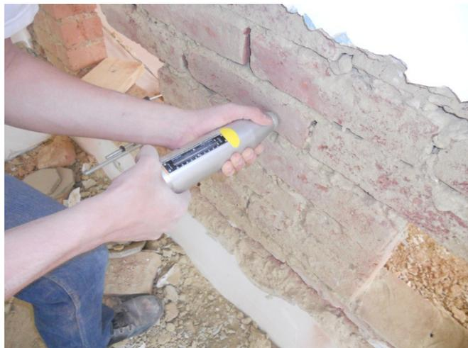
Abb. 4.5: Auslösen des Schlagbolzens samt anschließender Fixierung
