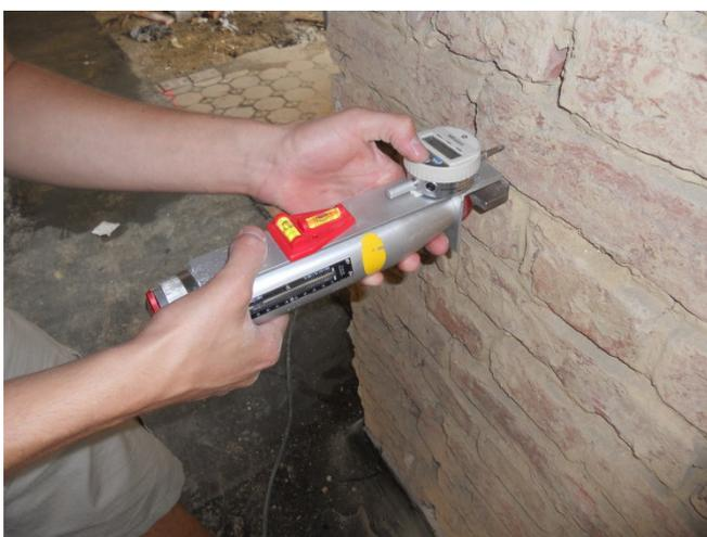
Abb. 4.12: Justieren des Prüfgerätes
