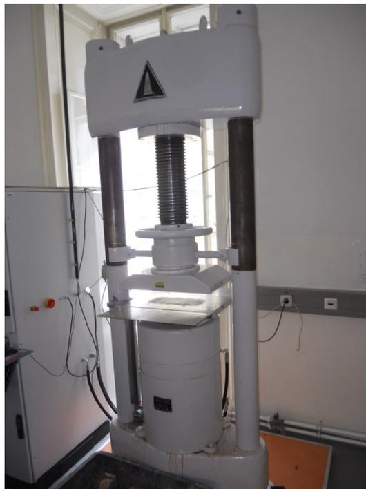
Abb. 4.16: Druckprüfmaschine [NOW13]
