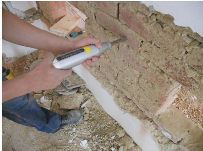
Abb. 4.4: Ansetzen des Prüfhammers auf die vorbereitete Stelle
