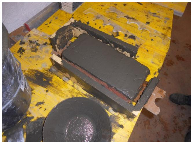
Abb. 4.15: Abgeglicherer Mauerstein [NOW13]
