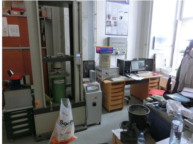
Abb. 4.20: Druckprüfmaschine
