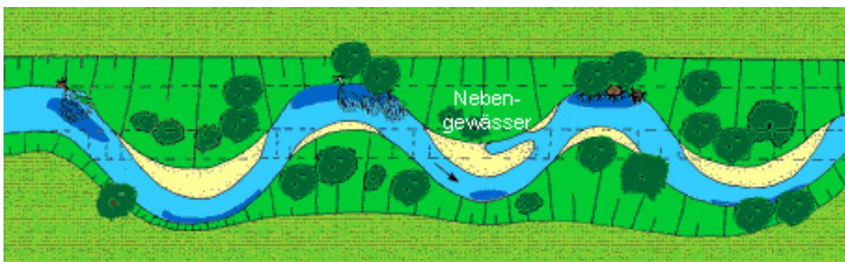
Abbildung 6: Maßnahme „Pendelnde Linienführung durch Aufweitung des HW-Profils (M4)“
