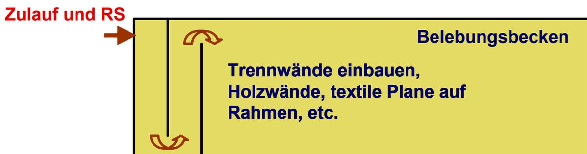
Abbildung 11-46: Schema einer Kaskadierung des Einlaufbereichs des Belebungsbeckens.
