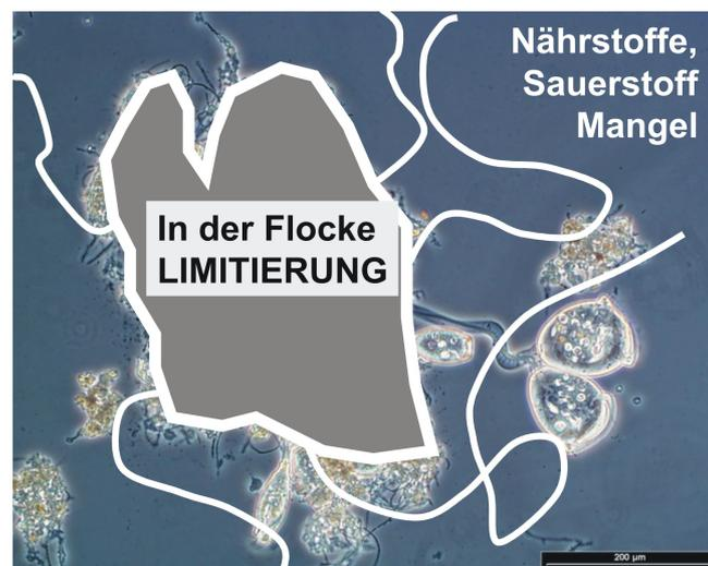
Abbildung 11-43: Substratmangel, nur der äußere Bereich der Flocke ist gut versorgt, Fadenorganismen haben einen Vorteil.
