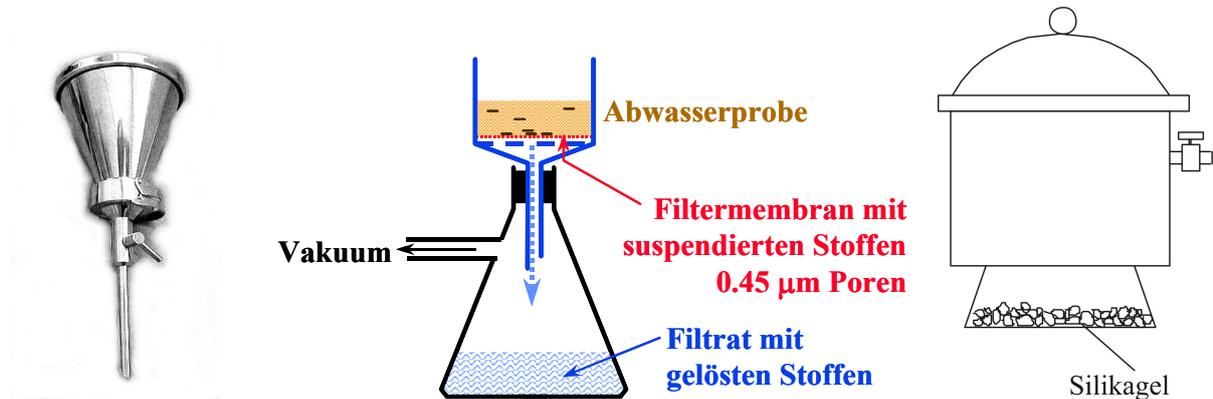
Filtrationseinheit Apparatur für Membranfiltration (Schema)
