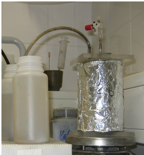
Abbildung 1 Versuchsaufbau der Anaerobreaktoren
