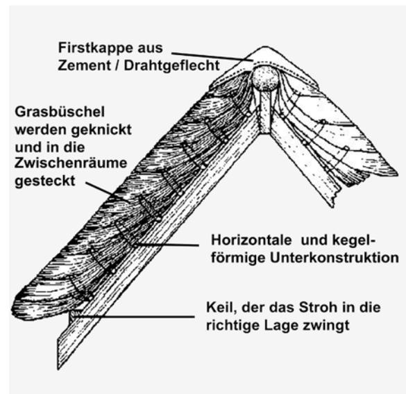
Abb.133: Gras wird in die Zwischenräume des "Dachkorbs" ohne zusätzliche Befestigung gesteckt.
