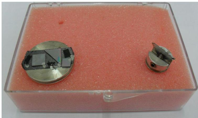
Abbildung 28 REM-Probenhalter: Links zur Untersuchung der Oberfläche, Rechts zur Bruchkantenanalyse
