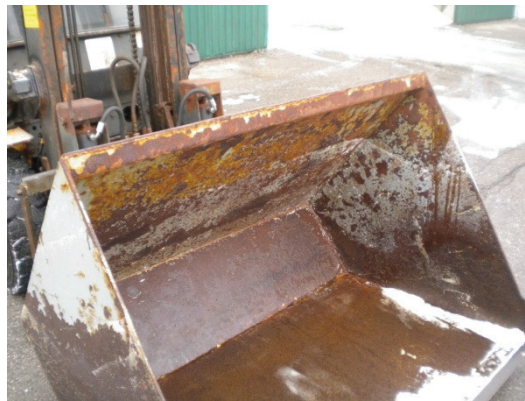
Abb. 14: Korrosion einer Stapler-Schaufel
