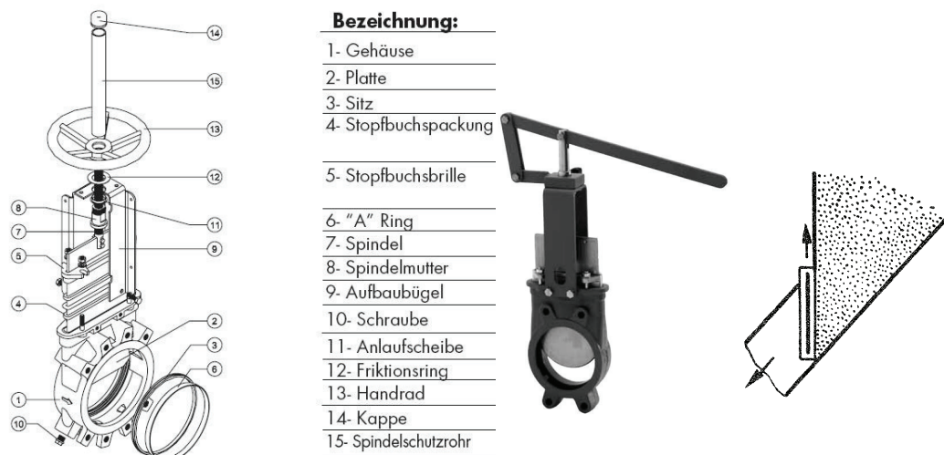
Abb. 17: Flachschieber 30 , Schnellschlusshebelschieber 31 , Bunkerverschluss 32
