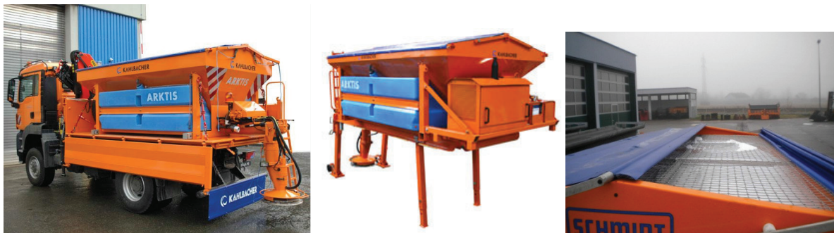
Abb. 33: Streufahrzeug 80 , Streuautomat Arktis 250 81 und Streufahrzeug offen
