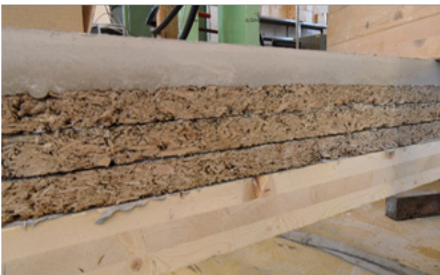
Abbildung III-10: Aufbau einer Holz-Holzleichtbeton-Beton-Hybridkonstruktion (61)
