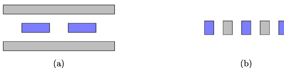
**Abbildung 1.6:** Durch Abschirmung (grau) kann das Übersprechen zwischen Signalleitungen (blau) verringert werden. Die Abschirmung kann entweder durch Masseflächen (a) oder Schirmleitungen (b) erfolgen.
