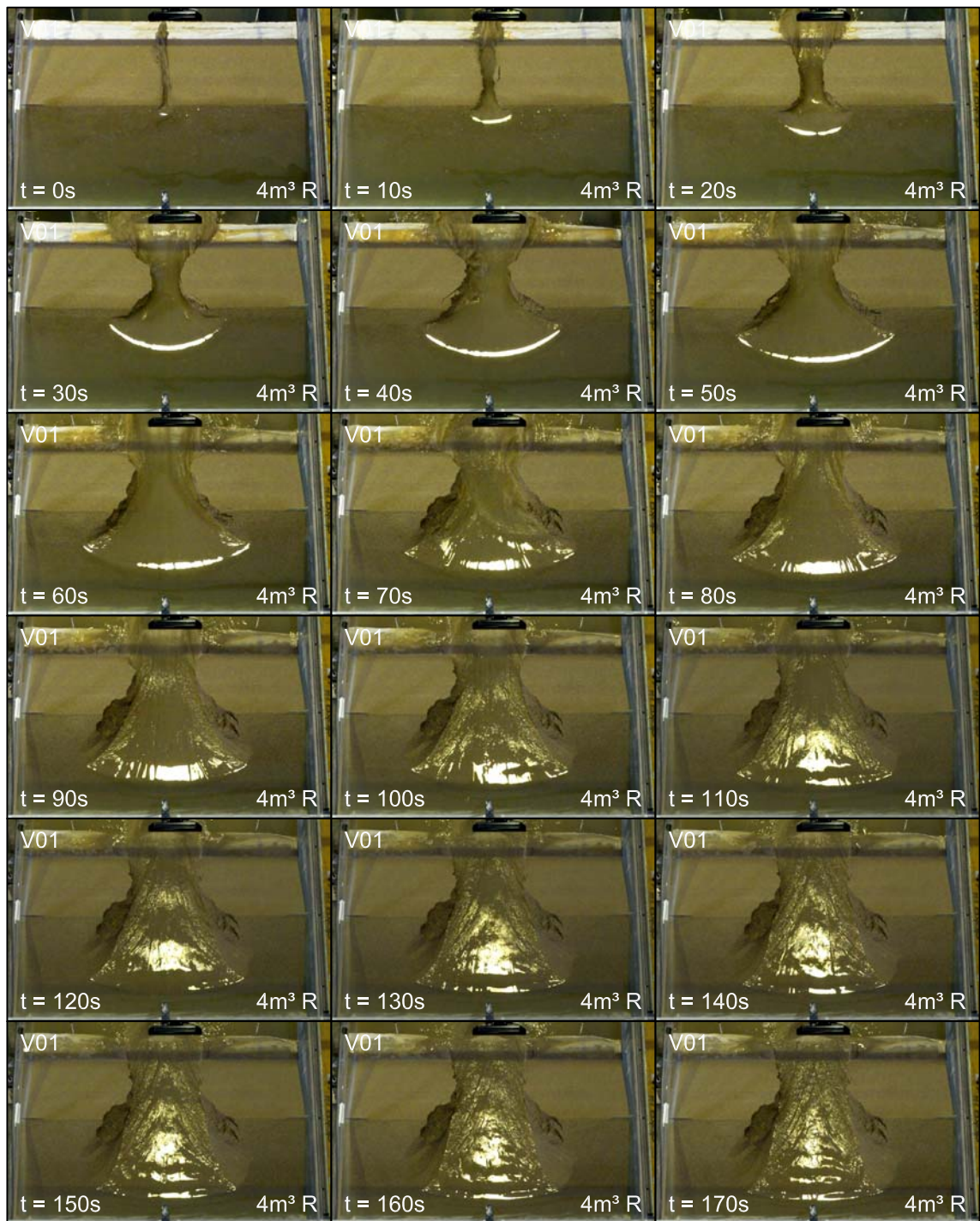
Abbildung 4.6: Versuch V01, Rechteckspeicher mit 4 m 3 , Fließrichtung von unten nach oben
