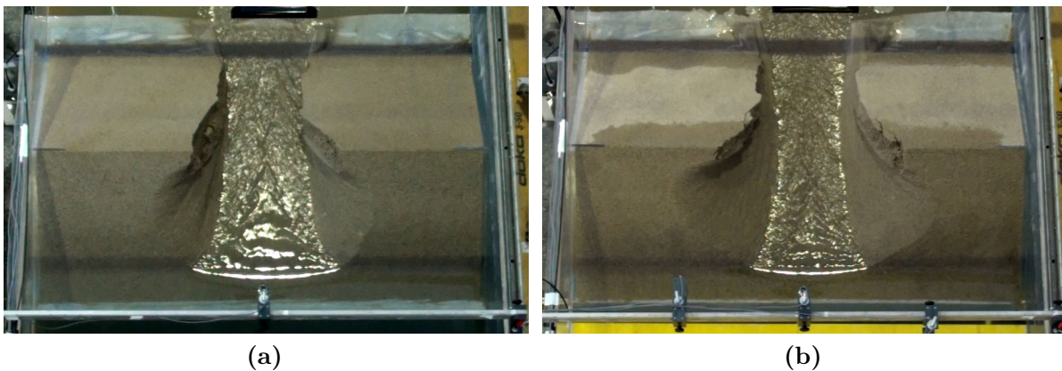
Abbildung 5.7: V04 und V13 mit 2 \text{ m}^3 Rechteckspeicher (a) bzw. Dreieckspeicher (b) nach 180 s
