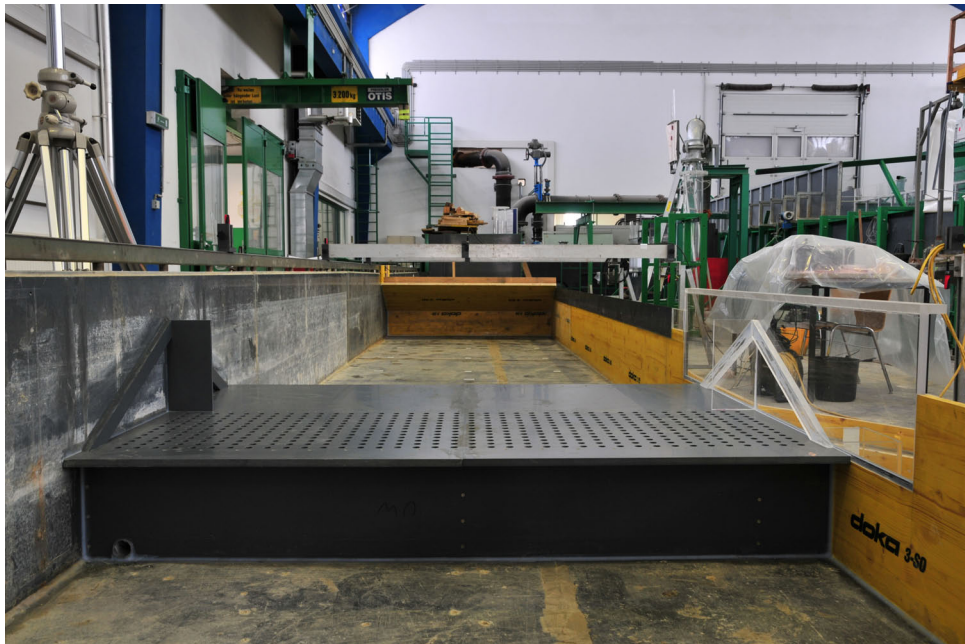
Abbildung 3.10: Modellstand für Dammbbruchversuche, Plattform mit Drainage und Einbauten zur Verlängerung der Fließwege an den Seitenwänden, Ansicht von der Unterwasserseite
