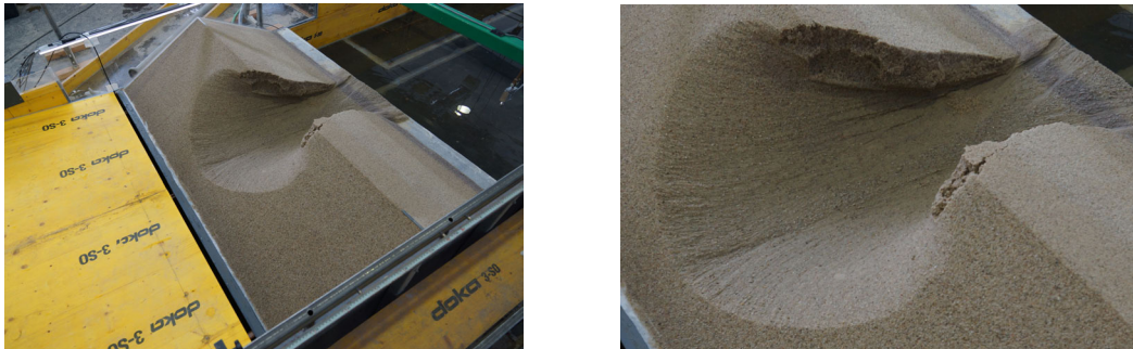
Abbildung 4.22: Finale Breschenform nach Versuch V10
