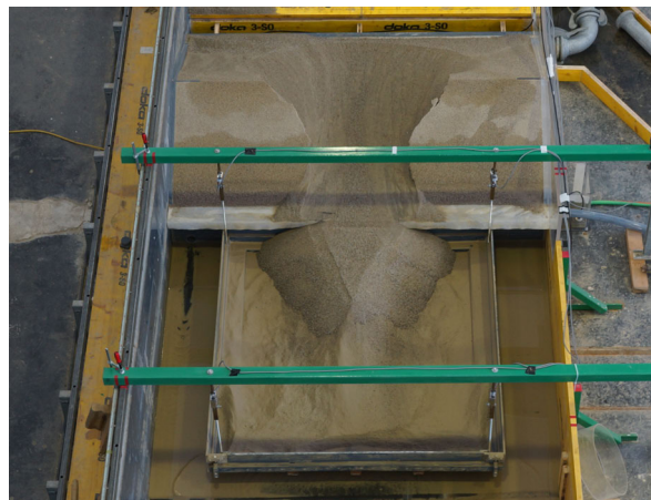
Abbildung 5.2: Sedimentfalle und Ablagerung in der Rinne nach Versuch V16
