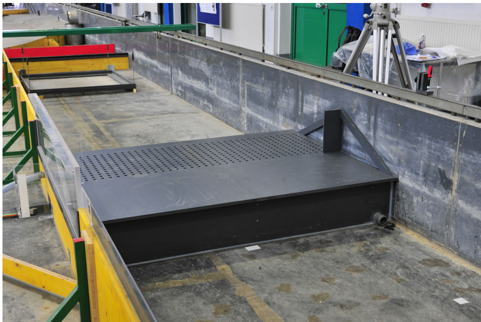
Abbildung 3.11: Modellstand für Dammbbruchversuche, Plattform mit Drainage und Einbauten zur Verlängerung der Fließwege an den Seitenwänden, Ansicht von der Oberwasserseite
