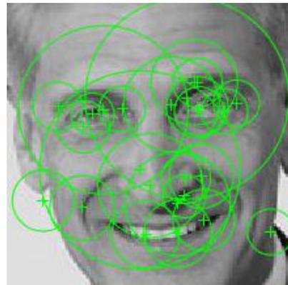
Abbildung 2.7: Berechnung der dominierenden Orientierung eines „Point of interest“ mit Hilfe eines Fensters, das in mehreren Schritten über die Kreisregion geschoben wird, Quelle: Bay et al. [17]
