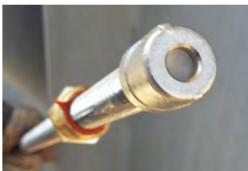
Abbildung 5.8.: Messsonde mit Schutzsieb [7].
