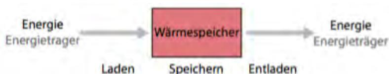
Abbildung 1.1.: Funktionsprinzip von Energiespeicher [17].
