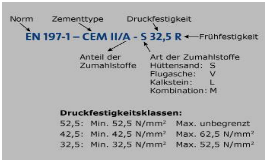
Abbildung 2-5: Bezeichnung der Zemente nach ÖNORM EN 197-1
