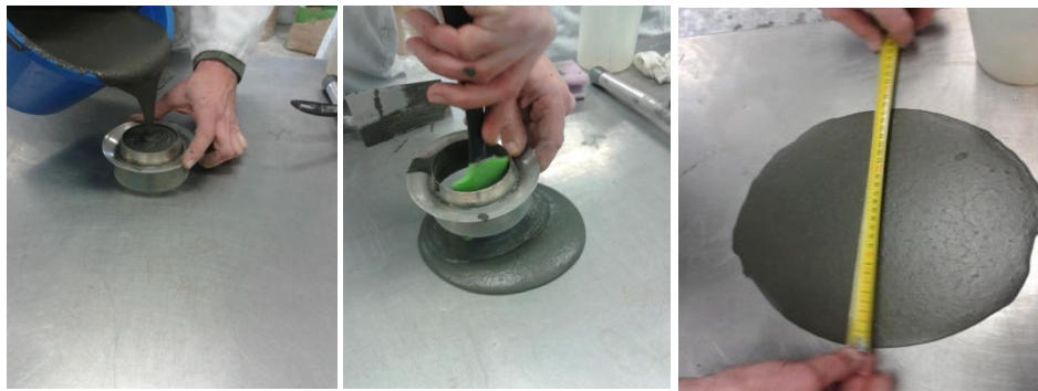
Abbildung 3-7: schematisches Foto der Bestimmung des Fließmaßes mit dem Setztrichter (Foto)
