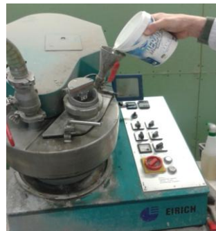
Abbildung 3-4: Verfahrenprozess – Mischreihenfolge; Laborfoto
