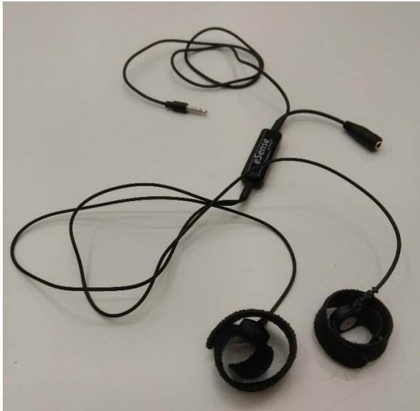
Abbildung 12: verwendetes Hautleitfähigkeitsmessgerät eSense Skin Response der Firma Mindfield Biosystems; Quelle: eigene Erhebung 2017
