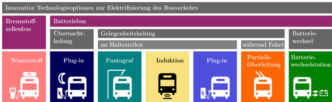
Abbildung 2.16: Möglichkeiten der Betankung von elektrisch betriebenen Bussen nach einer Einteilung von [41]
