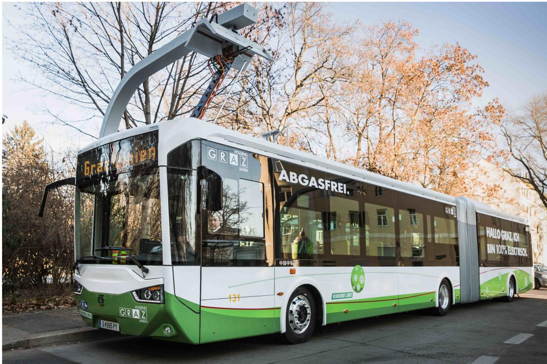
Abbildung 5.1: Ein E-Bus der Holding Graz bei einer Flash-Ladung des Supercaps an einer entsprechenden Ladestation (Quelle: Holding Graz).
