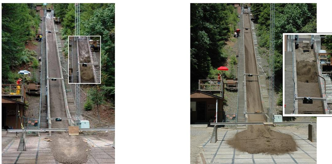
Abb. 2.8: Simulation von Sturzprozessen in der USGS Debris-Flow Flume (Iverson et al., 2018).
