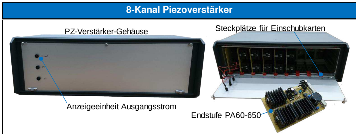
Abbildung 69: Vorder- und Detail-Ansicht des 8 Kanal Piezoverstärkers
