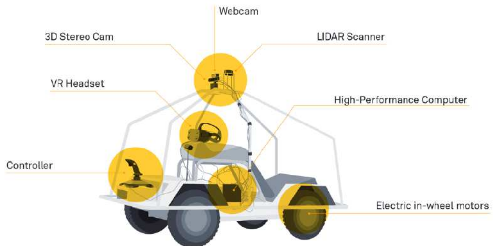
Sensoren und Ausstattung des Fahrzeugs (Quelle: https://selfdriving.moovellab.com [Zugriff: 25.07.2019])
