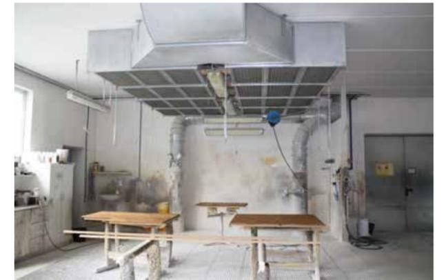
Abb.96 Lackierstand und Absaugungsanlage
