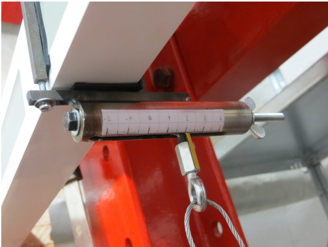
Abbildung 4.6: Montierte Schubflussklemme mit Millimeterabständen
