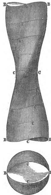
Abbildung 1.1: Torsionsversuch an einem Probekörper mit elliptischem Querschnitt [2]
