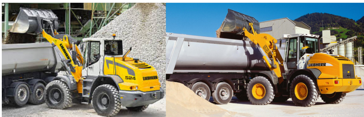
Abb. 41: Radlader L 524 (Fa. Liebherr)
