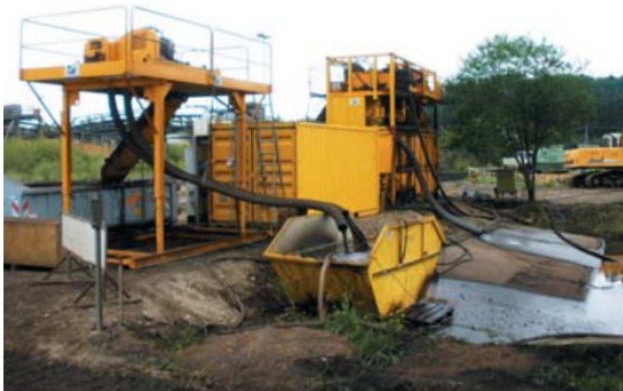
Abb. 38: Zentrifugenstand (Fa. ITE GmbH)
