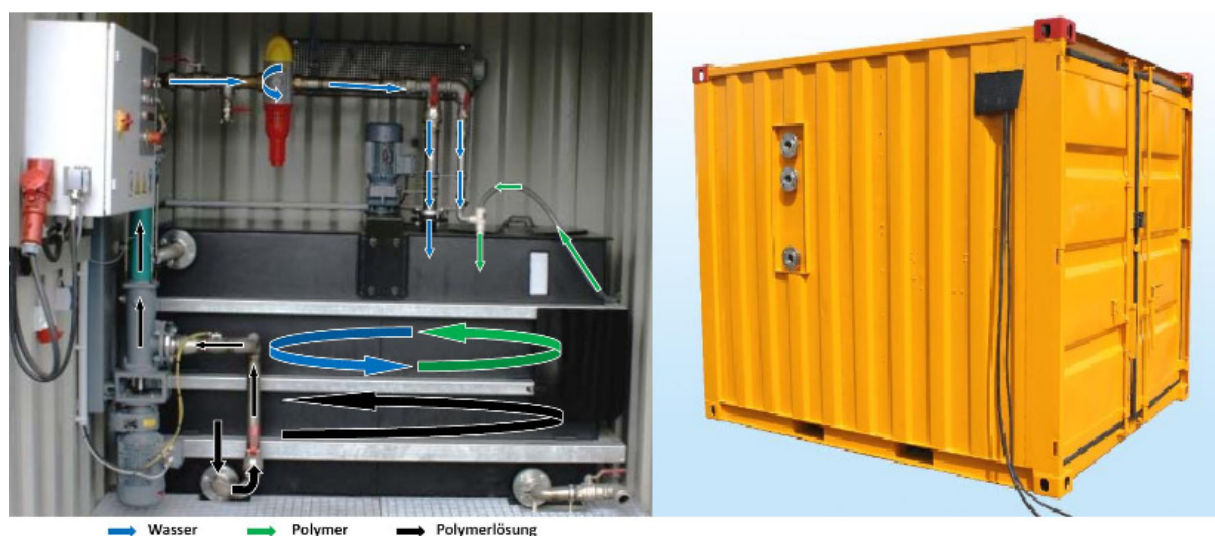
Abb. 33: Flockungsmittelanlage MiniFlock (Fa. ITE GmbH)
