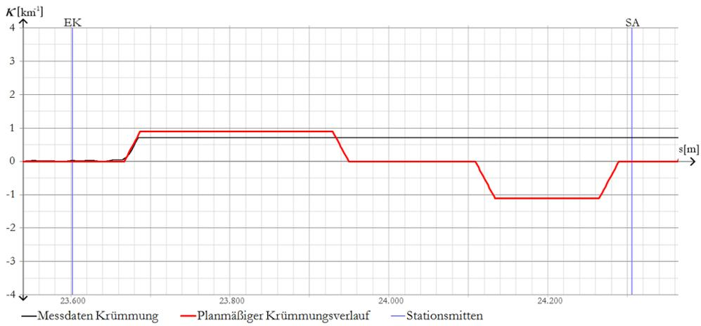
Abbildung 5.15.t: Überlagerung der Messdaten der Krümmung mit der planmäßigen Krümmung, Gleis 1, EK-SA
