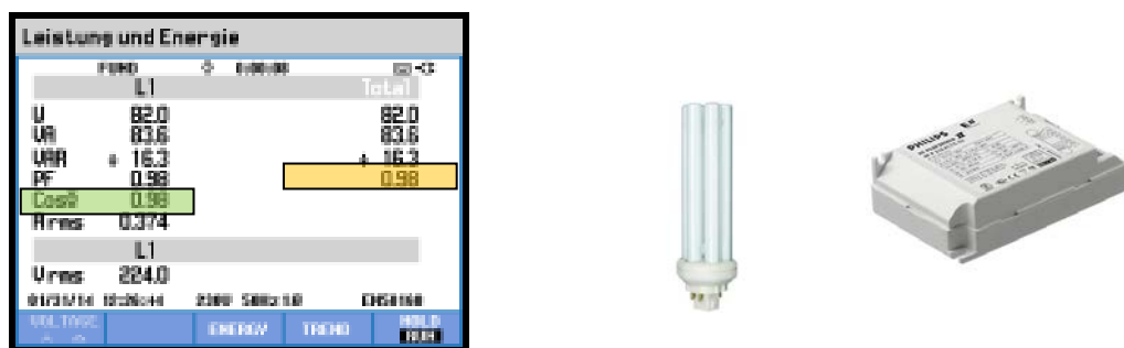
Abbildung 29 Darstellung u.a. der Leistungsfaktoren \cos\phi und PF des Probandens 04 (links) Probanden 04 (rechts) 53
