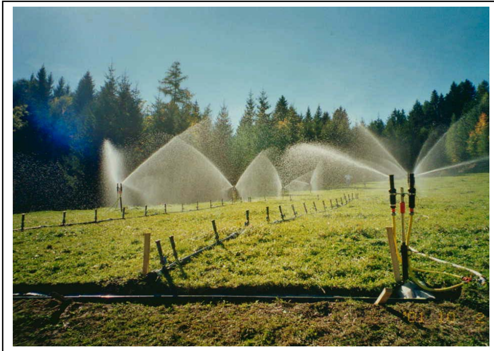
Foto 24: Beregnungsanlage vom Institut für Naturgefahren und Waldgrenzregionen Innsbruck (Quelle: MARKART & KOHL 1994).
