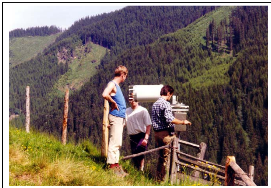
Foto 1: Datenauslesen und Kontrolle des Niederschlagsschreibers Herzogalm.
