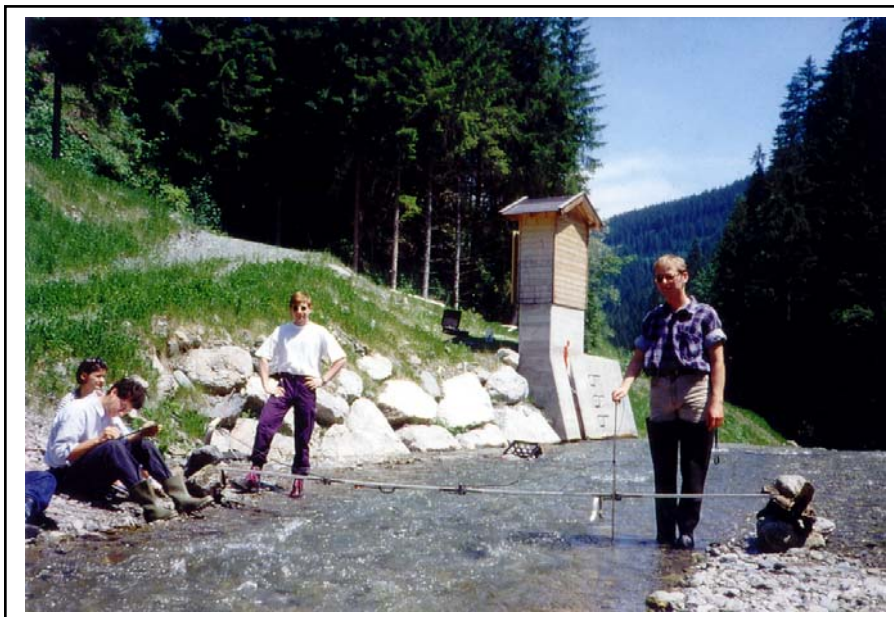
Foto 3: Durchflussmessung mit einem hydrometrischen Flügel an der Pegelstation Rammern.
