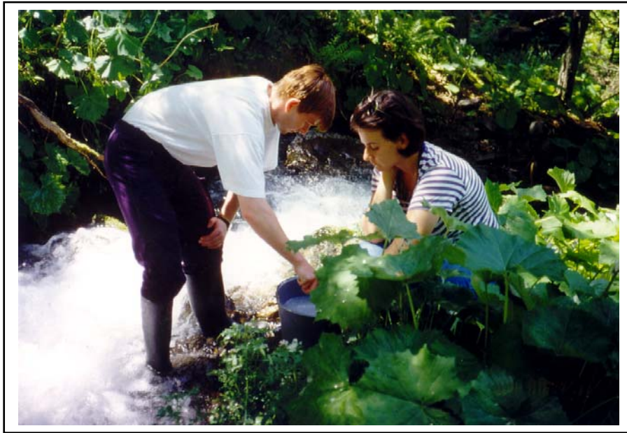
Foto 2: Vorbereitung der Salzlösung für die Durchflussmessung mittels Salzmischungsmethode am Klamm bach.
