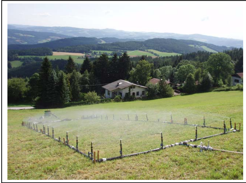
Foto 23: Beregnungsanlage für Starkregen vom Institut für Naturgefahren und Waldgrenzregionen Innsbruck.
