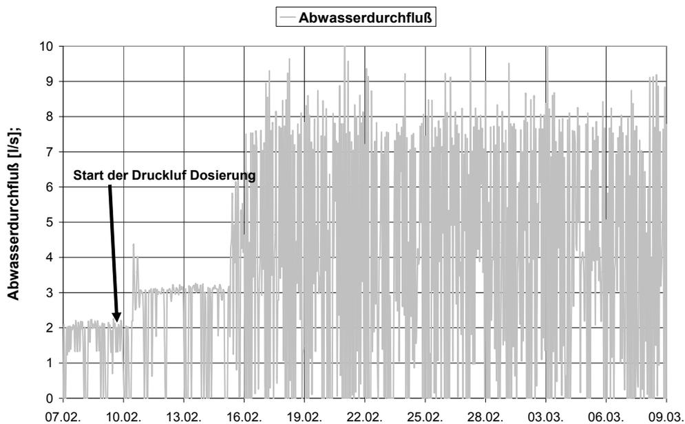
**Abbildung 74:** Anstieg der Förderleistung der Pumpen bei Pumpwerk Autobahnraststätte Guntramsdorf
