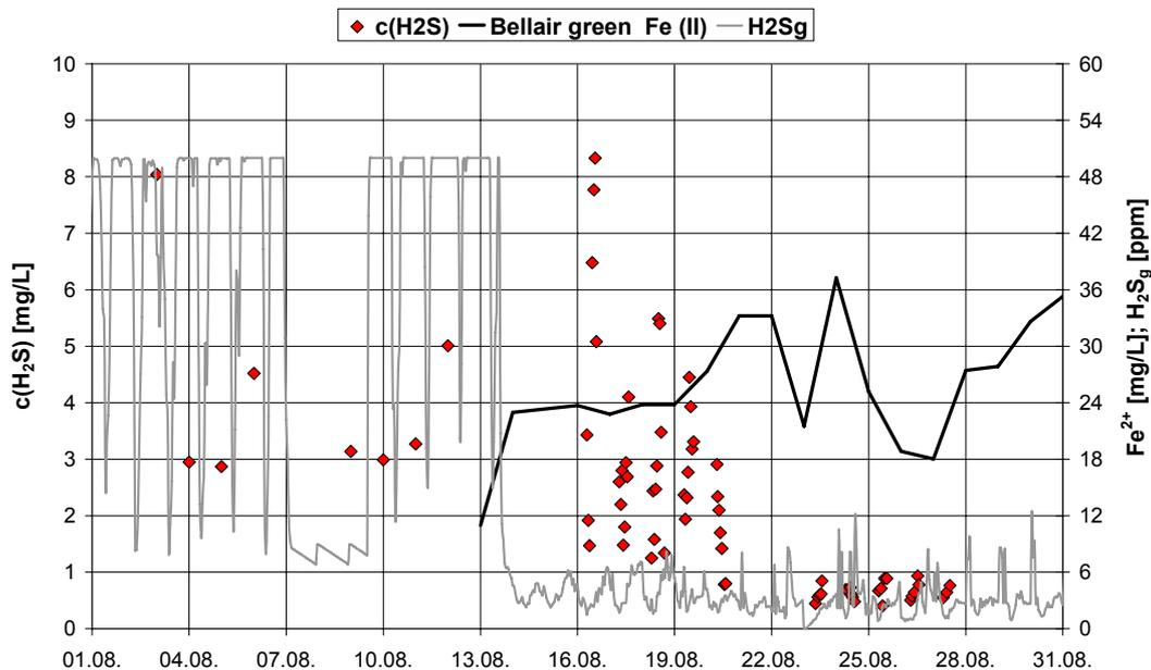
**Abbildung 59:** Sulfidbekämpfung durch Eisen(II)salz Zugabe beim ABA Guntramsdorf
