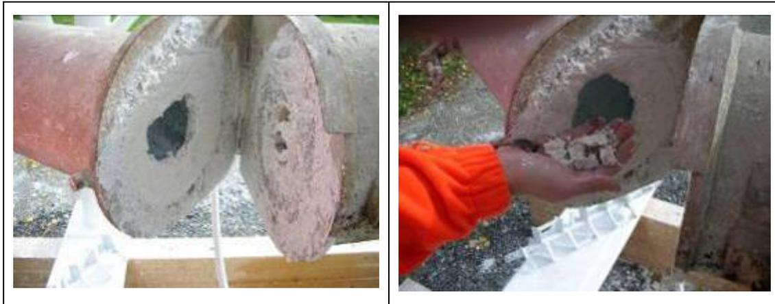
**Abbildung 45:** Verstopfung der Kalkmilch Dosiereinheit beim AWV Seewinkel
