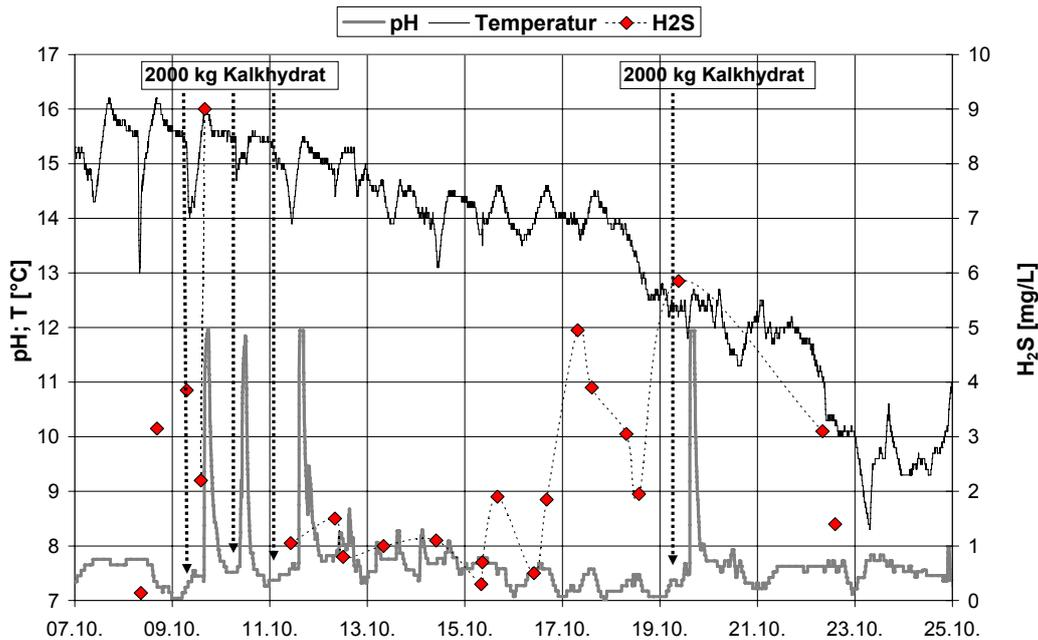
**Abbildung 46:** Abwassertemperatur, pH-Wert und Sulfidkonzentration im Zulauf AWW Seewinkel während der Kalkdosierung in der DL Illmitz-Apetlon-ZKA
