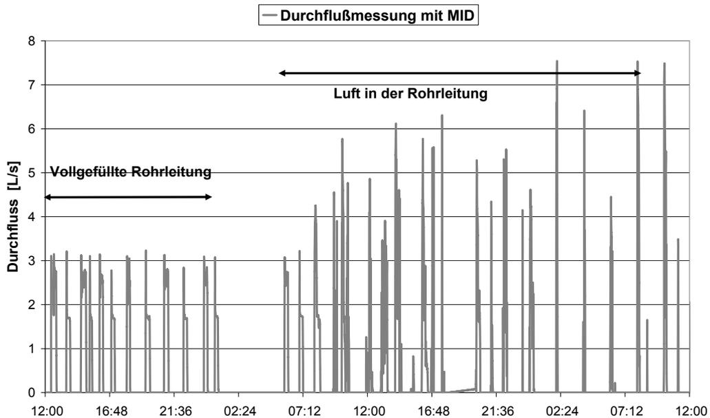
**Abbildung 75:** Ganglinie der Durchflüsse (Durchflußmessung mit MID) in der DL Autobahnraststätte Guntramsdorf
