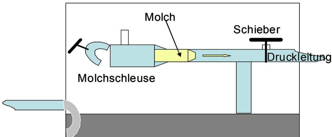
**Abbildung 31:** Pumpenschacht mit installierter Schleuse für Molch
