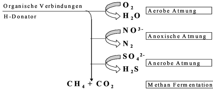
**Abbildung 6:** Schematische Darstellung der Vorgänge in der Sielhaut
