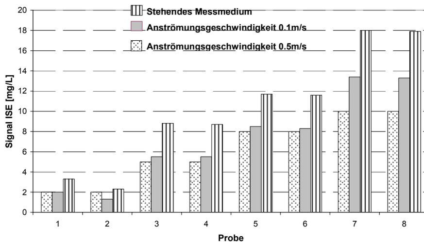
**Abbildung 10:** Messwerte einer ionensensitiven Elektrode bei unterschiedlicher Fließgeschwindigkeit
