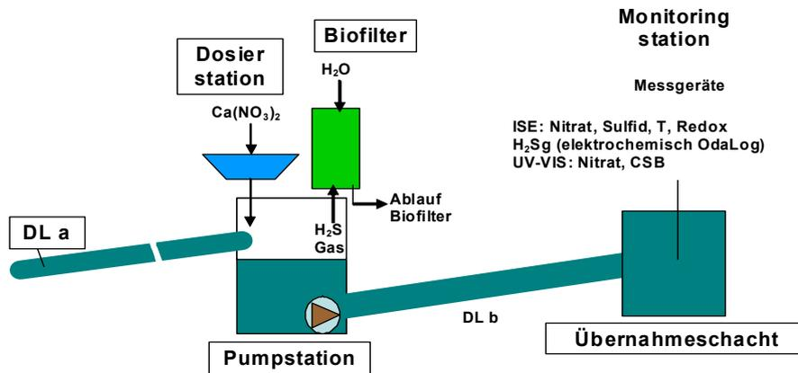
**Abbildung 48:** Schema Dosierstation für  $\text{Ca}(\text{NO}_3)_2$  und Übernahmeschacht mit Messgeräten
