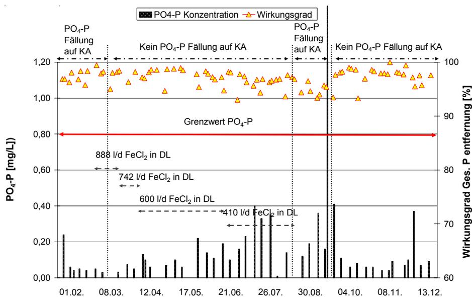
**Abbildung 64:** Ganglinie von PO<sub>4</sub>-P im Ablauf und Wirkungsgrad gesamt P Entfernung bei der KA des AWV Seewinkel Simultane
