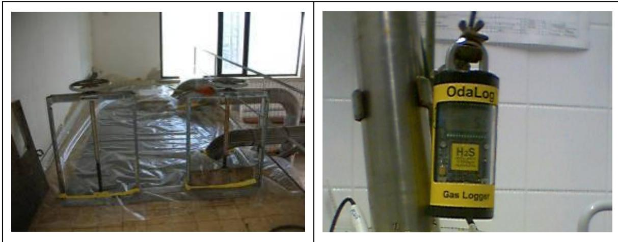
**Abbildung 17:** Abgedeckter Übernahmeschacht (links) und amperometrisches Sulfidgas-Messgerät (rechts)
