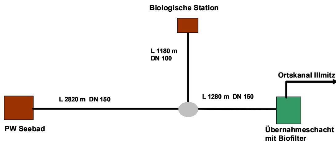
**Abbildung 37:** Schema Druckleitung Seebad Illmitz – Ortskanal Illmitz, AWW Seewinkel
