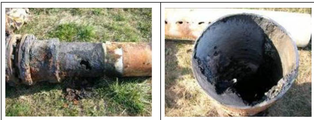
**Abbildung 27:** Korrosionsbeschädigungen Druckleitung Rusterberg (Matsche und Saracevic, 2007 b)
