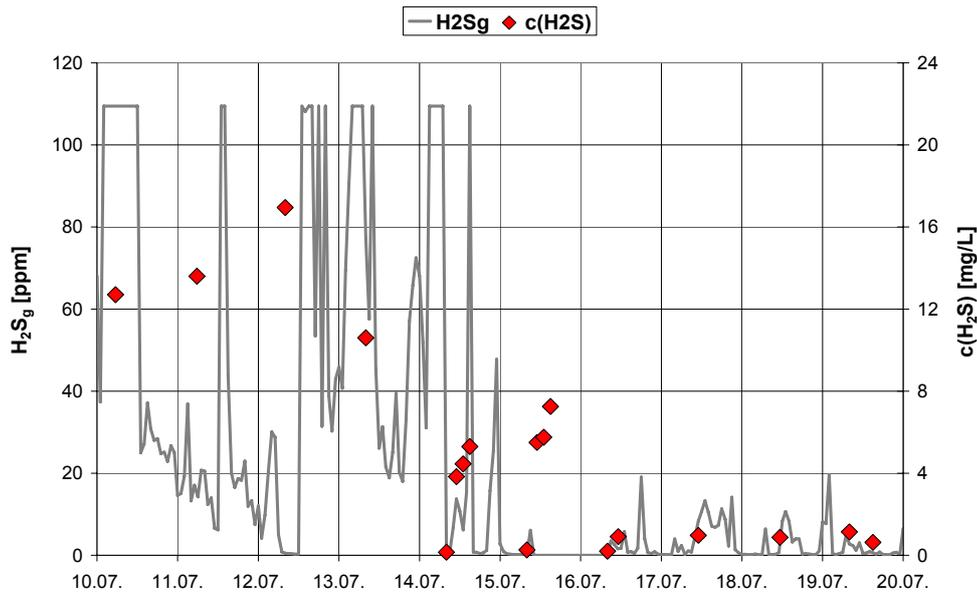
**Abbildung 22:** Vergleich H<sub>2</sub>Sg mit Gesamt-Sulfid c(H<sub>2</sub>S) Messungen
