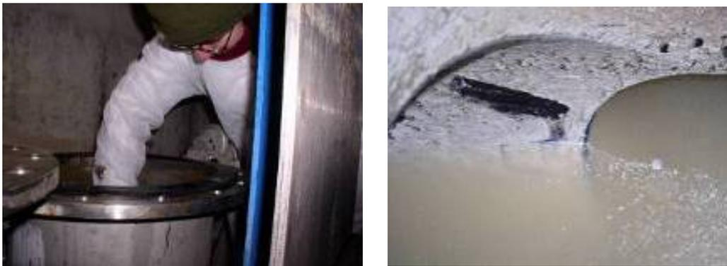
**Abbildung 83:** Sielhautentnahme für molekularbiologische Untersuchungen
