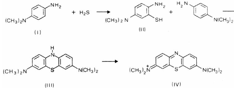
**Abbildung 8:** Reaktionen von Schwefelwasserstoff bei der Methylenblaumethode
