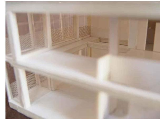
Die Wohneinheiten basieren auf einem durchgängigen Raster. Einerseits können so möglichst viele Teile günstig vorgefertigt werden, andererseits kann auch der individuelle Umbau im Trockenbau mit standardisierten Teilen durchgeführt werden. Eventuell können nicht mehr gebrauchte Trennelemente, Türen etc. günstig an eine andere Hauspartei weiterverkauft werden.
