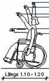
Abbildung 7: Vertikale Reichhöhe [http://nullbarriere.de/images/features/symbole/pik\\_a\\_p13.jpg](http://nullbarriere.de/images/features/symbole/pik_a_p13.jpg)
