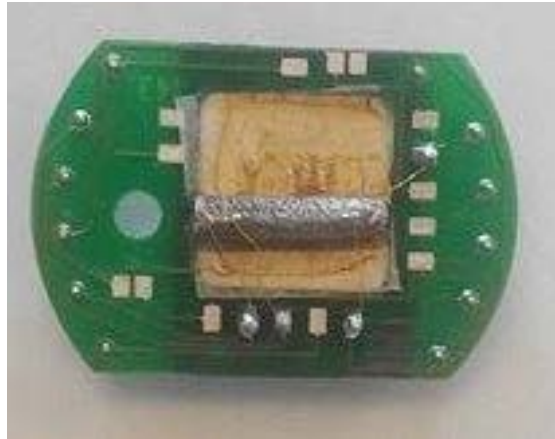
ABBILDUNG 3.5: Bild einer kontaktierten präparierter Probe für die Messung des spezifischen elektrischen Widerstands.
