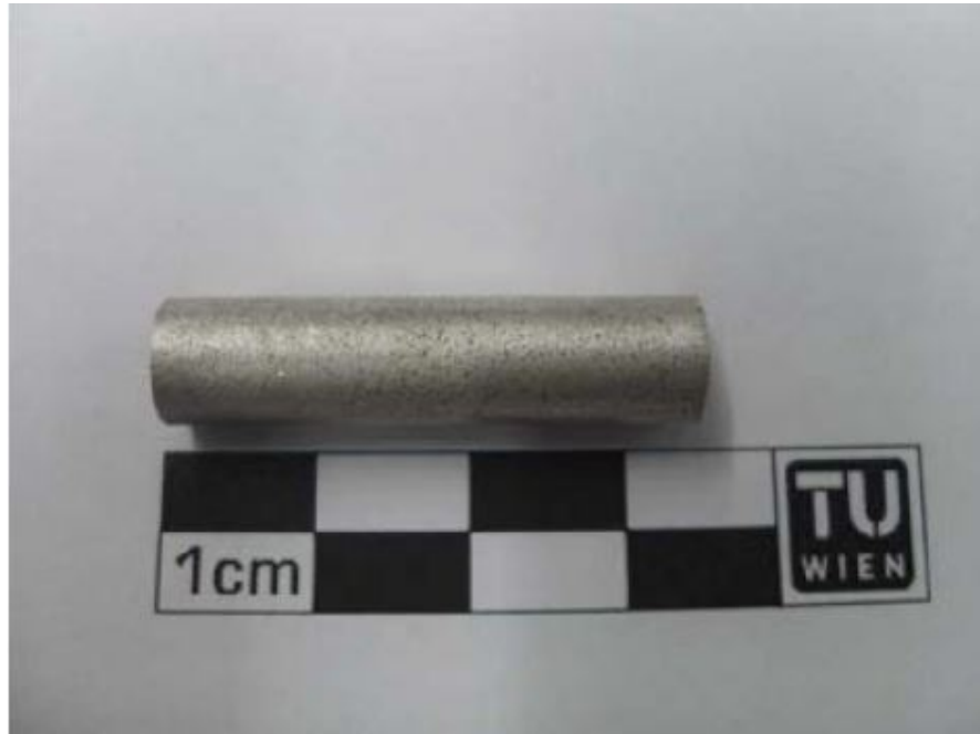
ABBILDUNG 4.5: Typische Probe einer \text{AgSi} -Zusammensetzung mit Diamanten [21].
