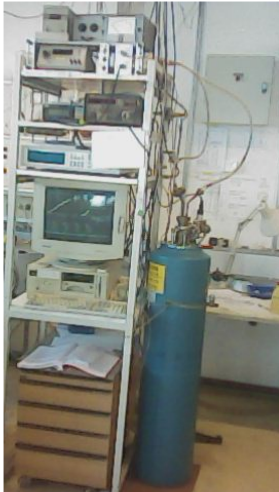
ABBILDUNG 3.7: Messanlage des elektrischen Widerstands.
