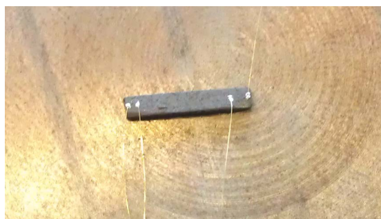
ABBILDUNG 3.4: Kontaktierte Probe mit vier Golddrähten [19].
