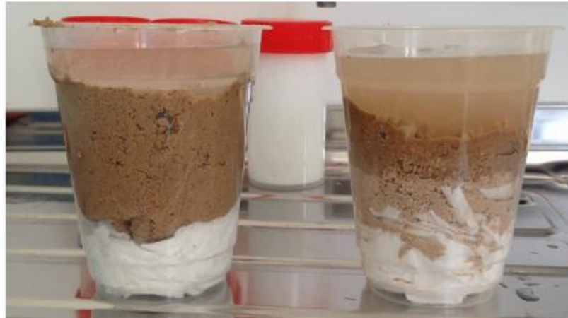
Abb. 4-12: Visualisierung der Wasserdurchlässigkeit mit (links) und ohne (rechts) Bodenconditionierung
