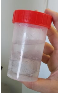
Abb. 6-19: Versuch – Widerstand Dichtmasse gegen Wasser am Beispiel des Produktes 2
