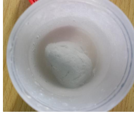
Abb. 6-20: Ergebnis – Widerstand Dichtmasse gegen Wasser am Beispiel des Produktes 2
