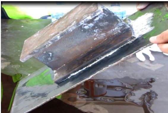
Abb. 6-35: Schritt 3 – Schrägstellen der Platte um 45° zur Horizontalen
