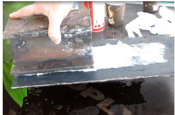
Abb. 6-36: Schritt 4 – Anheben des Trägers und messen der Dauer der Adhäsion
