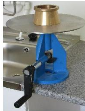
Abb. 4-11: Setzmaß - Versuch – Laborcontainer
