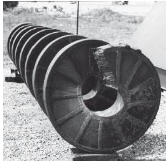
Abb. 3-7: Schneckenwendel ohne Seele (seelenlos) 32
