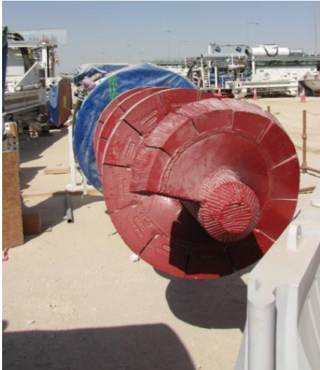
Abb. 3-6: Schneckenwendel mit Seele - Green Line Underground Doha
