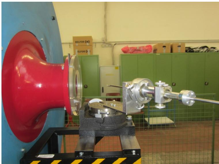
Abb. 20 Haltevorrichtung mit Sonde und Düse
