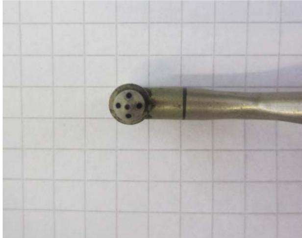
**Abb. 13 Messbohrungen AVA 203**
