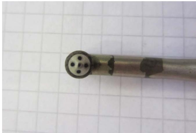
Abb. 7 Messbohrungen AVA 134
