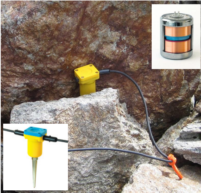
Abbildung 25: omnidirektionales Geophon (14Hz) (links unten), Ankoppelung eines Geophones im grobblockigen Untergrund, Aufbau eines Geophones (rechts oben)
