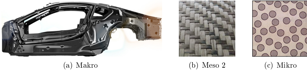
Abbildung 2.2: (a): Zeigt als Makro- Struktur das Chassis des BMW-i8 [1]. (b): Gewebehalbzeug. (c): Auf Mikro- Ebene sind die einzelnen Bestandteile des Verbundes deutlich zu erkennen [2].
