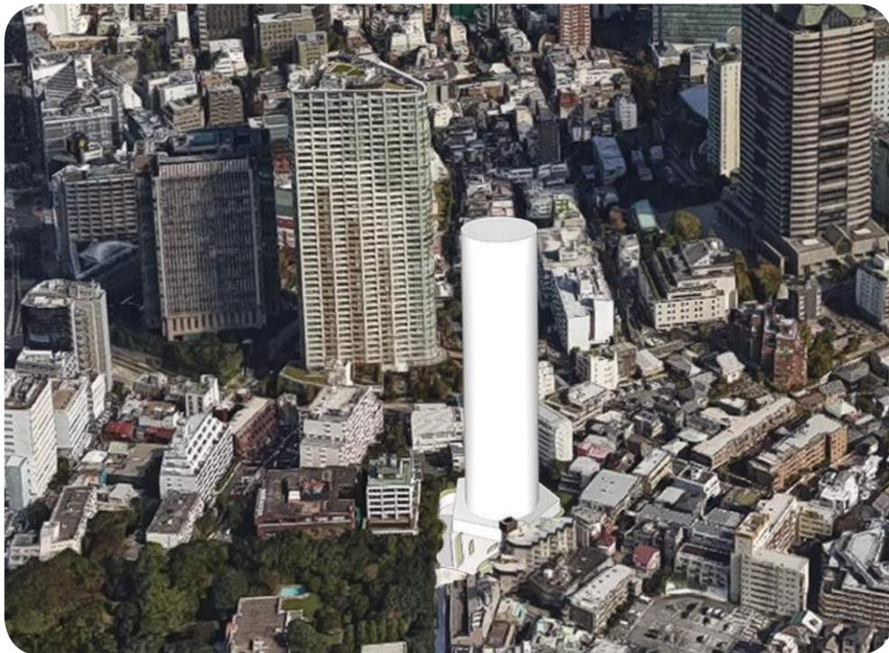
Abb. 64 zylinderförmige Umwandlung des Hochhauses aufgrund der Aussicht und besserer Windeigenschaften (eigene Darstellung)
