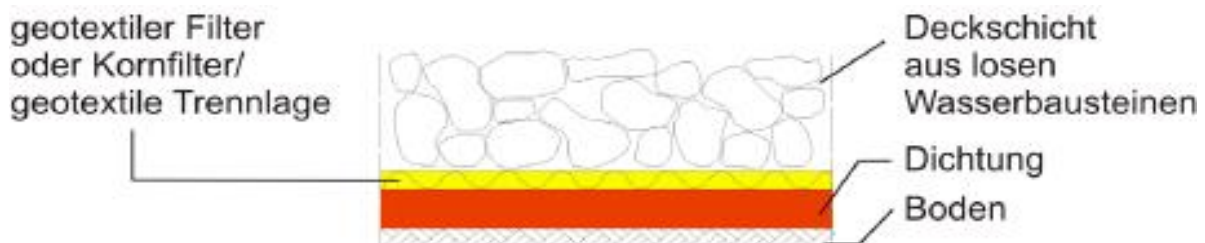
Bild3.4.2. Deckwerke mit einer Deckschicht aus losen Wasserbausteinen[40]
