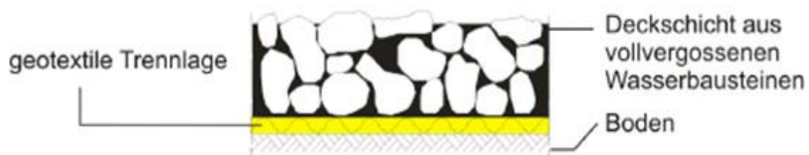
Bild 3.4.20 Deckwerke mit einer Deckschicht aus vollvergossenen Wasserbausteinen[56]
