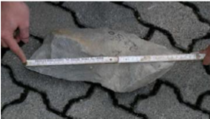
Bild 3.3.1. Größte Steinlänge L bzw. D [49]
