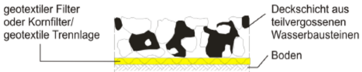
Bild 3.4.16. Deckwerke mit einer Deckschicht aus teilvergossenen Wasserbausteinen[56]
