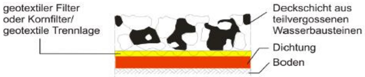
Bild 3.4.6 Deckwerke mit einer Deckschicht aus teilvergossenen Wasserbausteinen [40]
