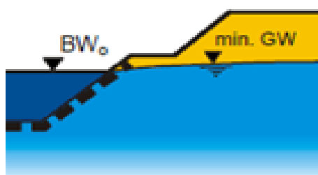
Bild 4.2.12. Kriterien für die Auswahl einer dichten oder einer durchlässigen Deckwerksbauweise [40]
