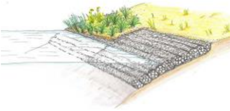
Bild 5.6. Steinmatratzen als Sicherungsbauweise [97]
