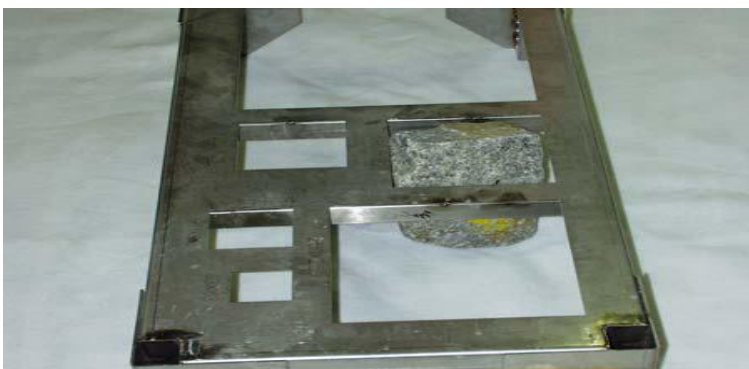
Bild 3.3.2. Größenermittlung D über ein Quadratlochsieb [49]
