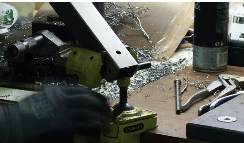
Abb.3.6.1-4 Einspannen der Teile zum Schneiden
