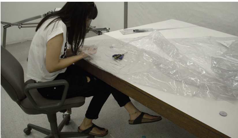
Abb.3.6.5-5 Verstärken der Schweißnähte
