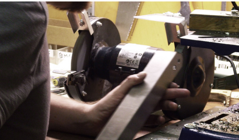
Abb.3.6.1-3 Schleifen mittels Schleifbock
