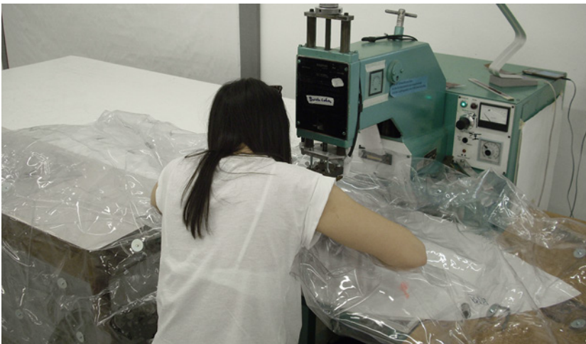
Abb.3.6.5-4 Verschweißen nach Zuschnitt
