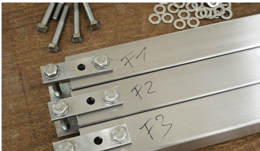
Abb.3.6.2-2 Vorbereitung der Gelenke
