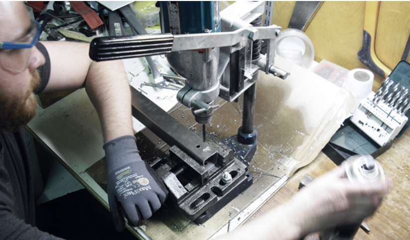
Abb.3.6.1-2 Bohren der Metallteile
