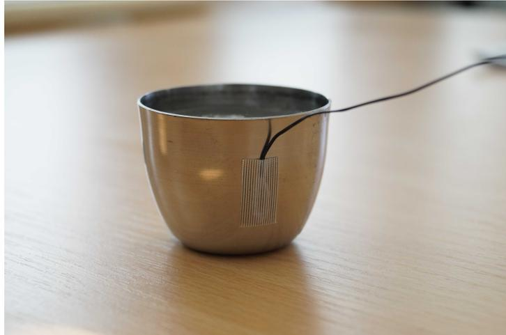
Abbildung 3.1.: Edelstahl-Messbehälter für das Vorexperiment mit aufgeklebtem Temperatursensor
