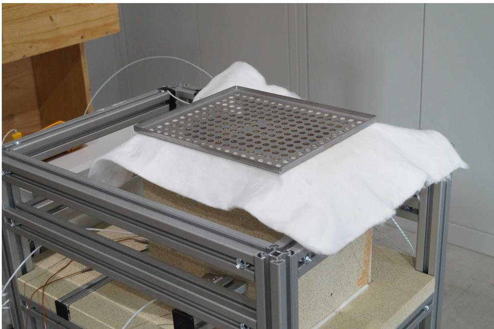
Abbildung 6.10.: Der Probenraum wird mit Cellulose-Vlies abgedeckt, für eine homogenere Temperaturverteilung und zur Erzeugung eines Überdruckes im Probenraum
