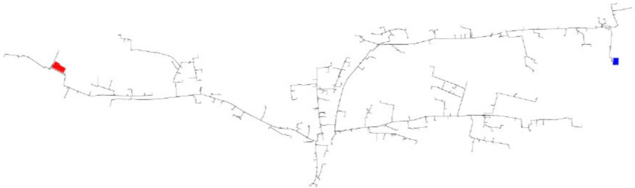
Abbildung 1: Johannes Nagler: Fernwärmenetz Großarl, rot: Heizwerk, blau: Schlechtpunktverbraucher
