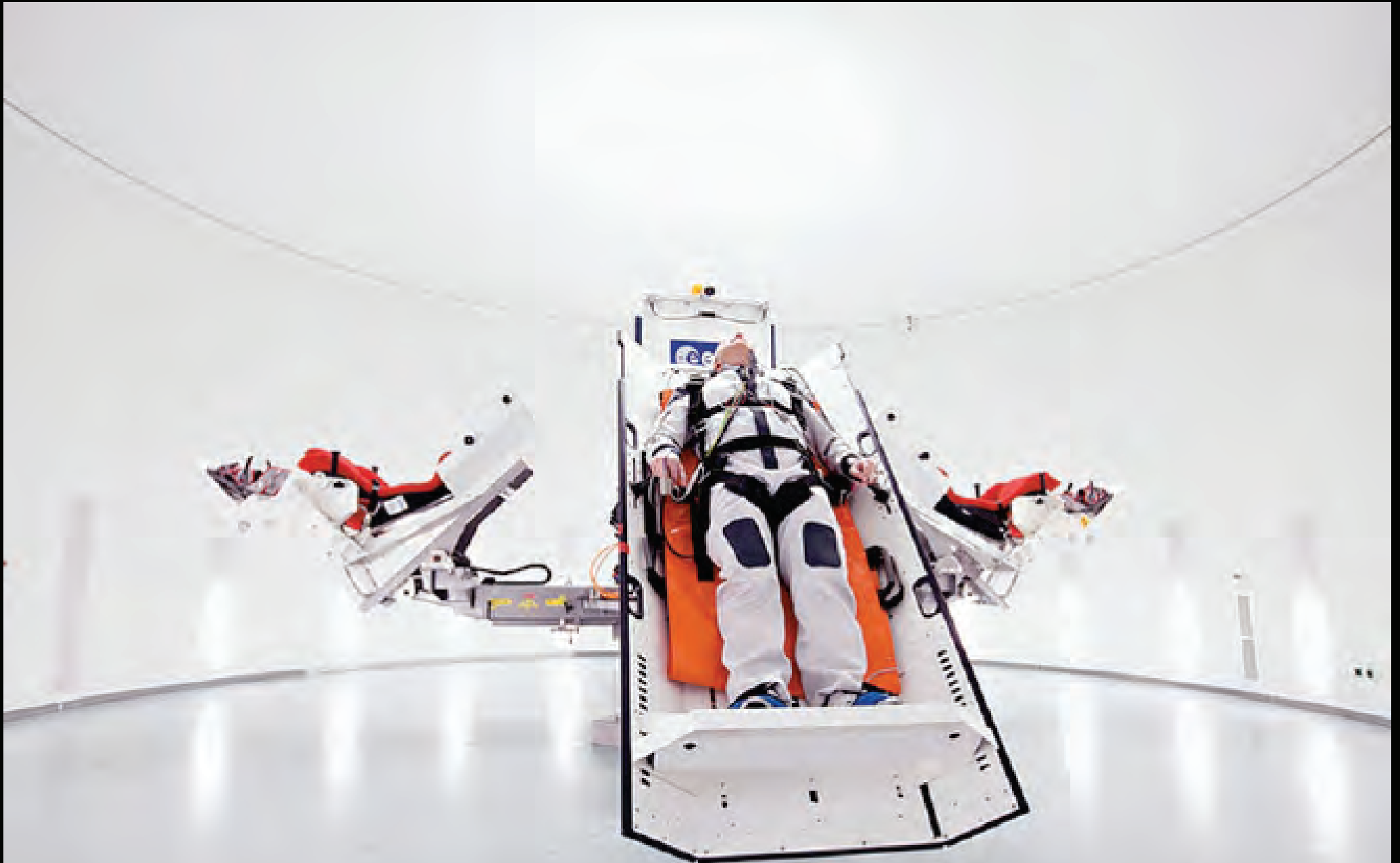
Abb.160: Sieht aus wie ein Raumschiff - ist aber eine Kurzarm-Zentrifuge, die man bis zu 45-mal pro Minute um die eigene Achse dreht. Das soll die Belastungen des Weltraumtourismus auf den menschlichen Körper erforschen.
