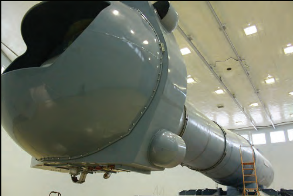
Abb.196: Die weltgrößte Zentrifuge simuliert die Beschleunigungskräfte
