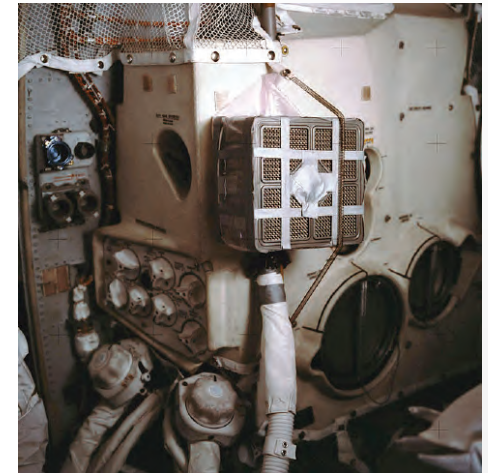
Abb.45: Der von den Astronauten gebastelte CO 2 -Filter in Betrieb
