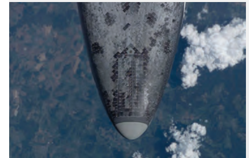
Abb.279: Hitzeschutzkacheln und Nase aus RCC auf der Unterseite der Kapsel
