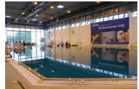
Abb.171: Im EAC befindet sich ein Schwimmbecken, das 17 m x 22 m groß ist und eine Tiefe von 10 m hat. Dort werden unter schwerelosigkeitsähnlichen Bedingungen Außeneinsätze im All geübt. Hierfür werden Modelle großer Raumstationsmodule in das Becken gelassen.
