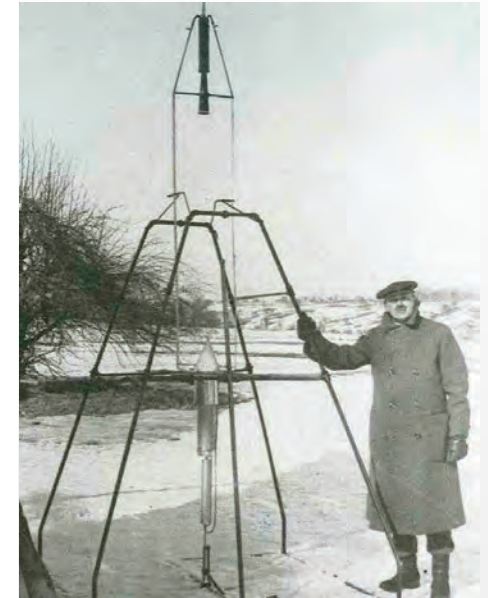
Abb.19: Am 16. März 1926 startete Robert Hutchings Goddard in Auburn, Massachusetts, die erste Rakete der Welt mit Flüssigkeitstriebwerk. Das Raketen-triebwerk ragt über das Startgestell hinaus, es ist durch Leitungen mit den unten befindlichen Treibstofftanks verbunden. Die Rakete stieg in zwei-einhalb Sekunden zwölf-einhalb Meter hoch und flog 56 Meter weit. Goddard konstruierte die gesamte Ausrüstung und entwickelte den Treibstoff selbst.
