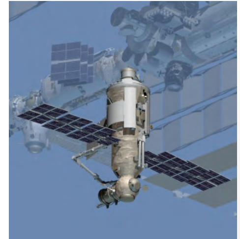
Abb.132: MLM mit installiertem ERA
