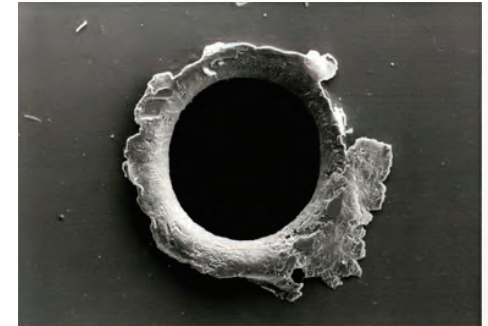
Abb.254: Ein Stück Weltraumschrott hat das Solar-Max-Experiment der NASA glatt durchschlagen.
