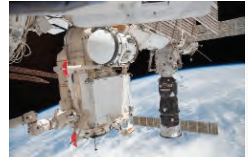
Abb.130: Rasswet (Vordergrund) und die seitlich angebrachten Kräne Strelas am alten Standort am Andockmodul Pirs.
