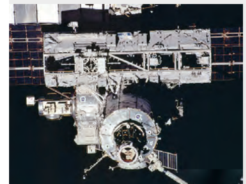
Abb.128: ISS nach Installation des Elements S0
