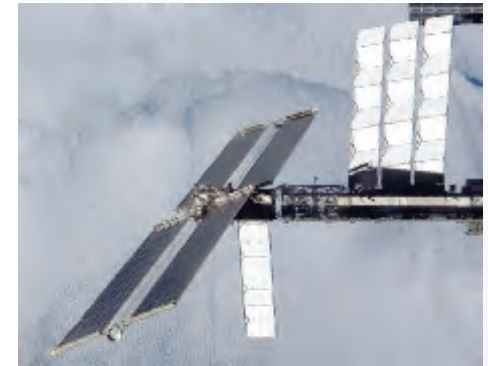
Abb.137: Abstrahler und Solarpanel
