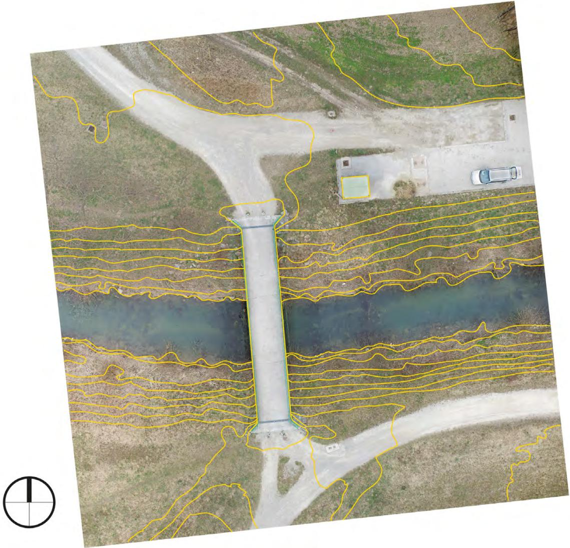
Abb. 2.8.5-2 Orthophoto mit Überblendung eines Höhenlinienmodells zu 0,5 Meter
