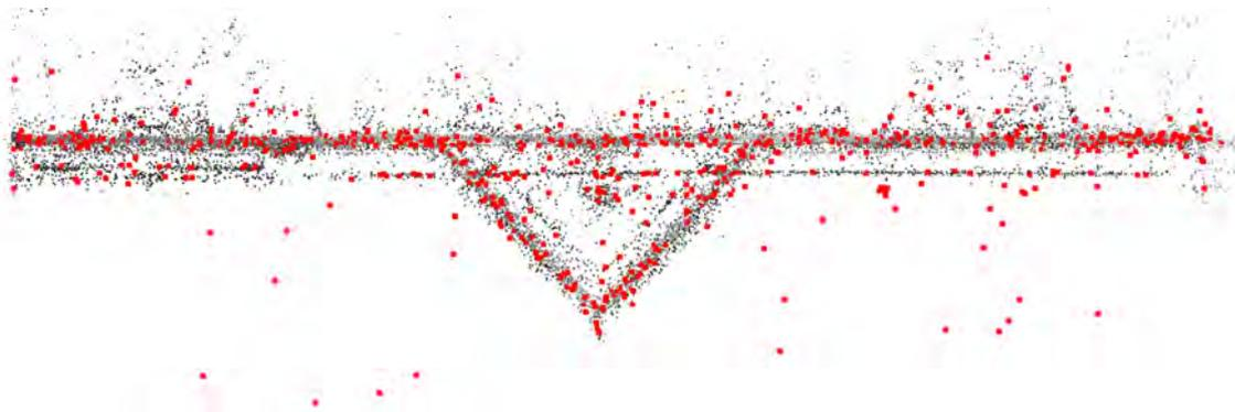
*Abb. 3.3-6 Parametrische Bereinigung der Sparse Pointcloud nach der Rekonstruktionsunsicherheit*
