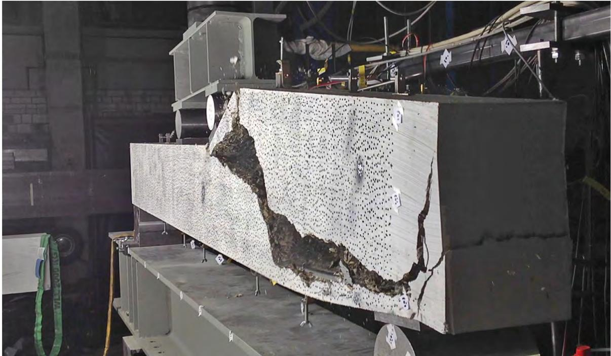
*Abb. 2.8.4 Signalisierter Probekörper, Stahlbetonbauteil unter Schubbeanspruchung*
