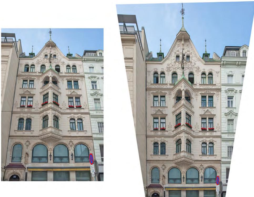
Abb. 3.1-1 Photographische Aufnahme und ebene Projektivtransformation
