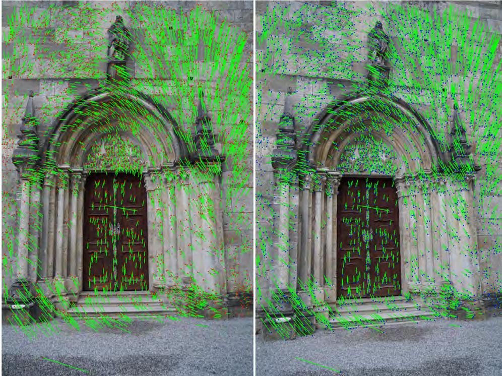
Abb. 3.3-3 Korrespondierende Merkmalspunkte (Feature Points) zweier Aufnahmen
