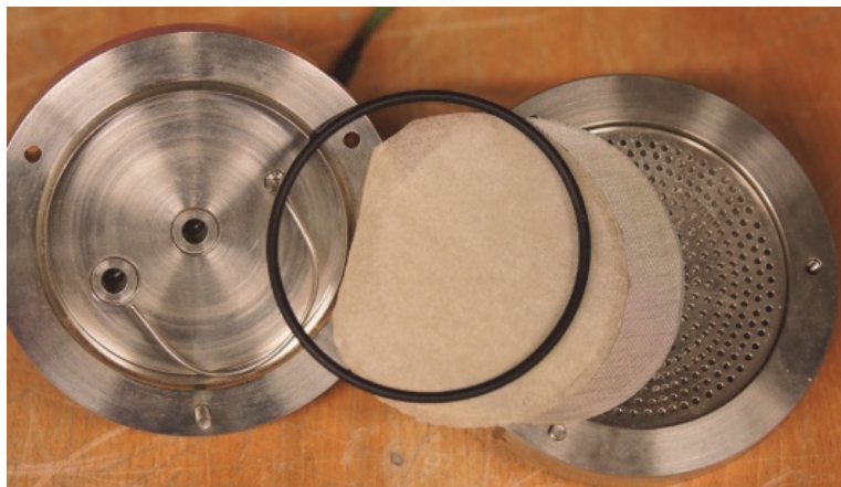
Abbildung 34: Am Institut für angewandte Synthesechemie hergestellte revers selektive (gummiartige) Flachmembran auf Basis von Polyvinylalkohol inklusive Trägermodul
