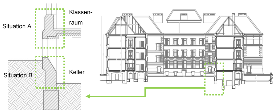
Abbildung 102: Grafische Darstellung der beispielhaft kritischen Randsituationen bezüglich Wärmebrücken; Plandaten aus SchulRen+
