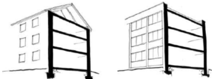
Abbildung 40: Darstellung einer Punktfassade (Massivbau) und Fassade bestehend aus Fassadenelementen (Skelettbau) aus (AEE Intec et al 2013)
