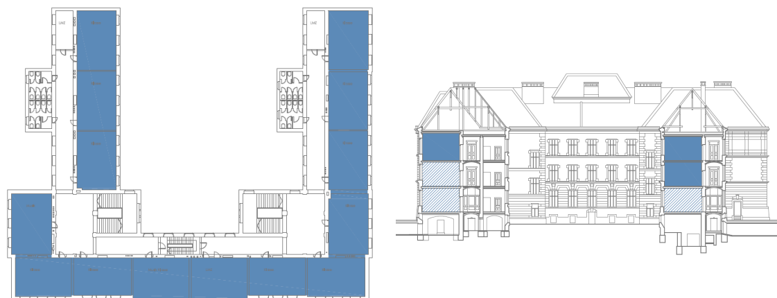
Abbildung 86: Belegungsplan der Franz Jonas Europaschule 2.OG und Schnitt; Pläne von gharakhanzadeh sandbichler architekten nach (Dubisch, et al. 2012)
