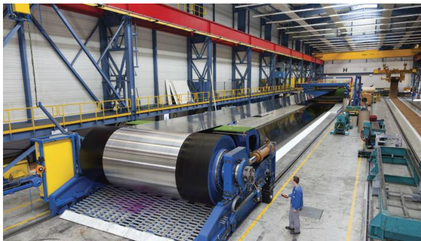
Abbildung 2.1: Stahlbandanlage Quelle: www.berndorf-band.at
