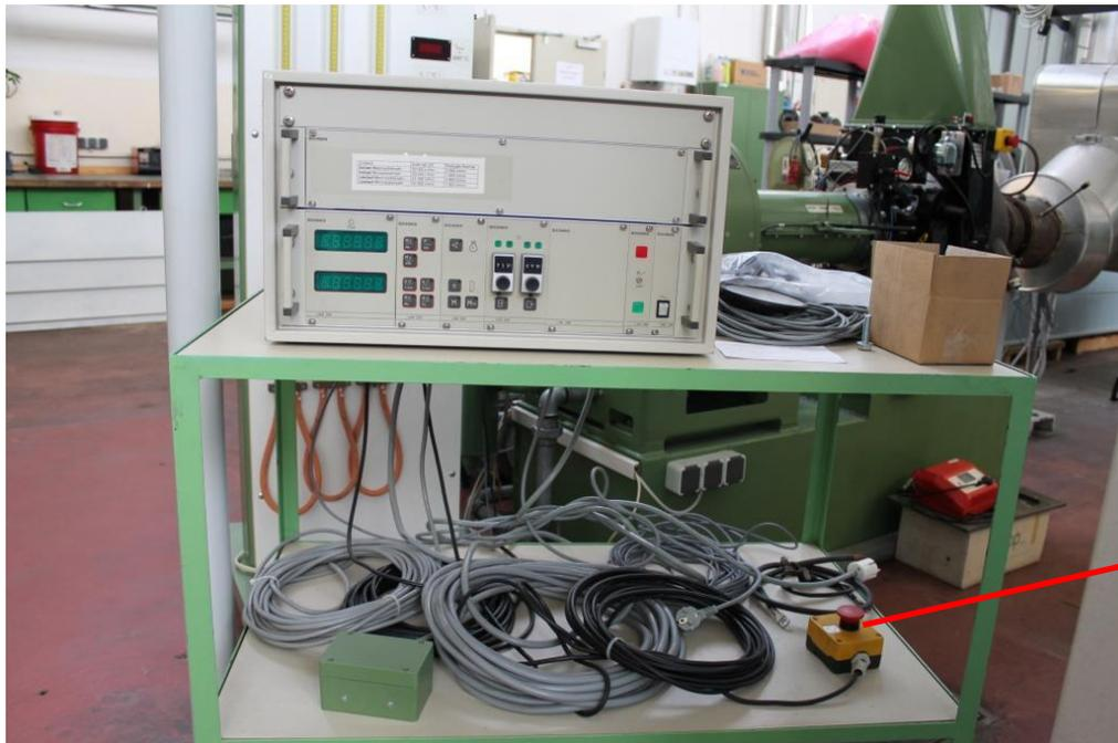
Abbildung 12 Not-Ausschaltung Wirbelstrombremse
