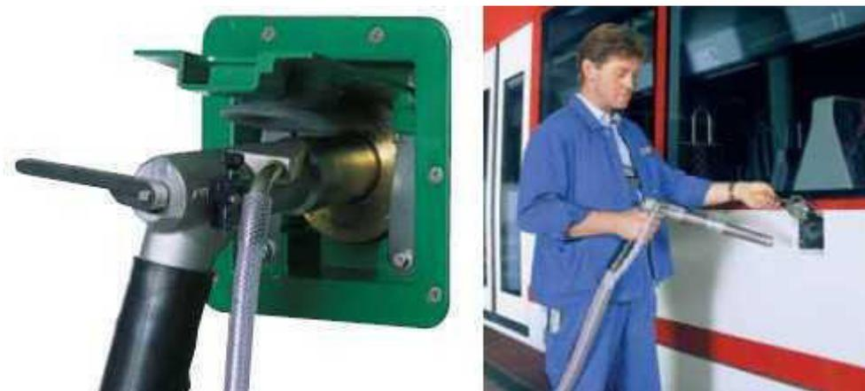
Abbildung 18: Beispiel für Ausführung und Positionierung des Befüllstutzens
