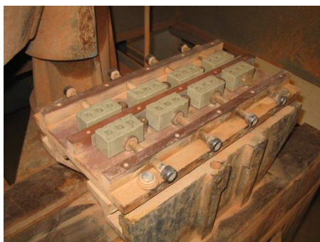
Abb.40: Schleifvorrichtung mit Lehmziegeln
