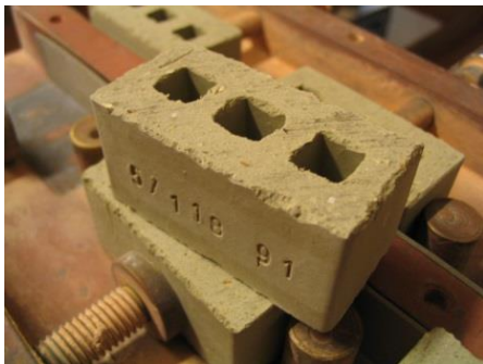
Abb.73: Modelllehmziegel Lehm mit Sägespäne
