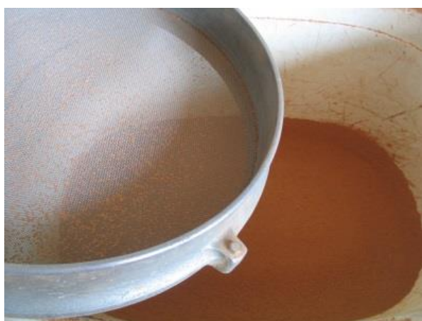
Abb.60: Ziegelmehl aussiebung 0-3,15mm
