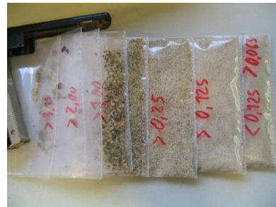
Abb.51: Lehm aus Göllersdorf GD gelb Siebstufenrückstände
