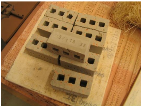
Abb.65: Modelllehmziegel mit Ziegelsplitt
