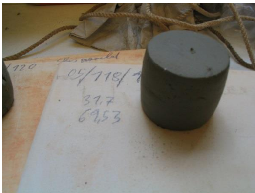
Abb.54: Prüfkörper nach Pfefferkornprüfung
