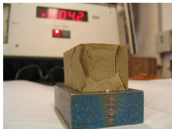
Abb.44-45: Druckkegelausbildung des Lehmziegels nach Druckversuch
