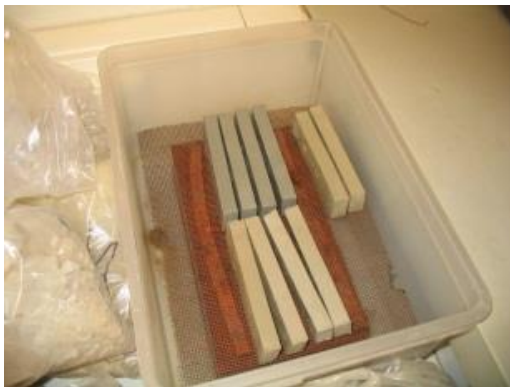
Abb.42-43: Feuchtlagern des Lehmziegels
